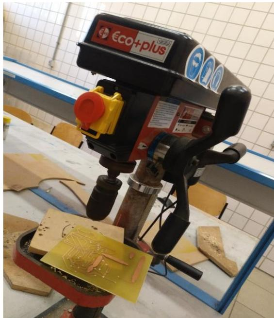
Figura 26 Mecanizado de la placa
