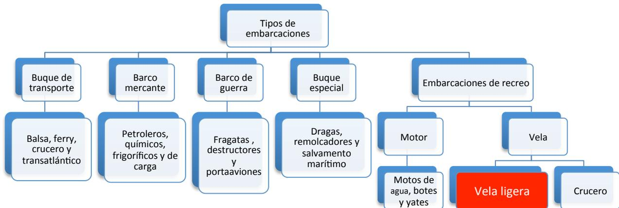
Figura 10. Tipos de embarcaciones
