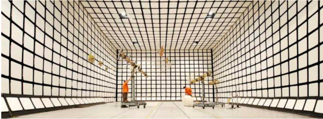
Figura 3: Interior de una cámara semi-anechoica en Applus.
