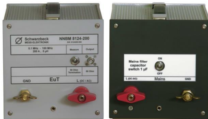
Figura 29: LISN de Schwarbeck Mess-Elektronik.
