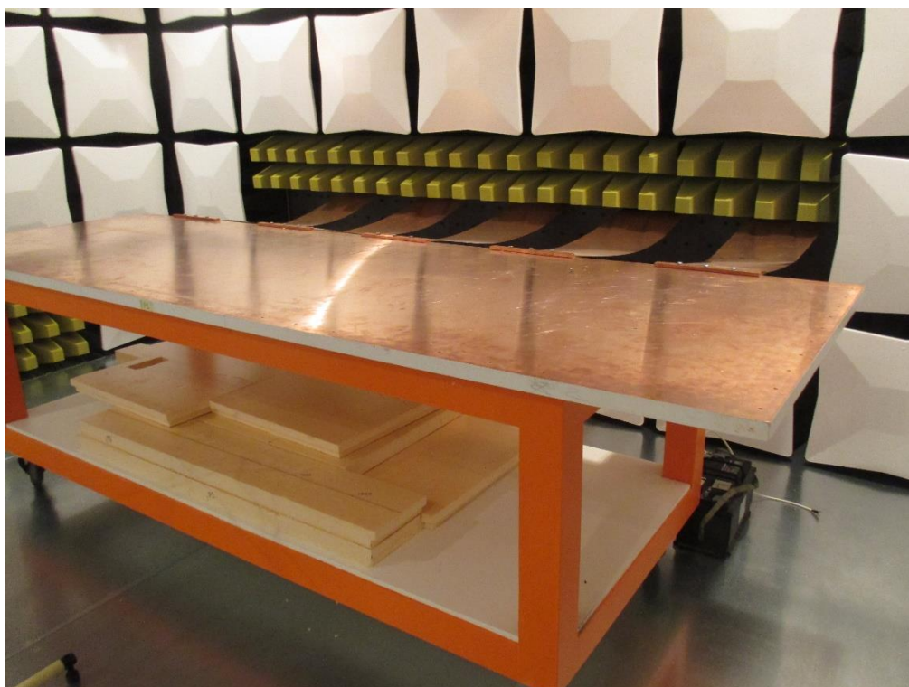
Figura 54: Plano de masa de referencia atornillado al blindaje de SAC 4.
