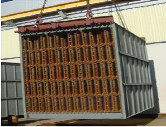
Figura 17. Enfriador de gases residuales
