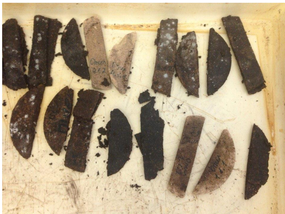
Рис. 1. Внешний вид образцов после испытаний на биостойкость
