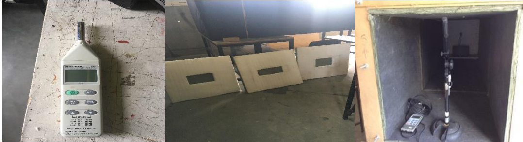
Figura 51. Fotos paneles y cámara reverberante
