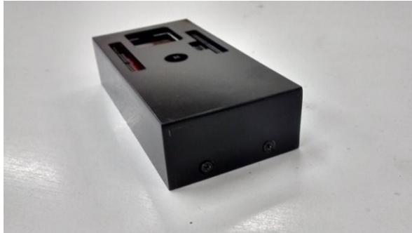
**Figura 2 (Tornillos de seguridad de cubierta exterior)**
