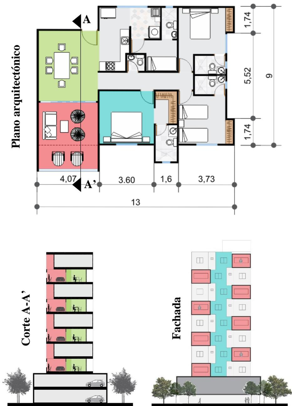
Ilustración 38. Diseño de Tipología 2 (Plano arquitectónico, corte y fachada).
