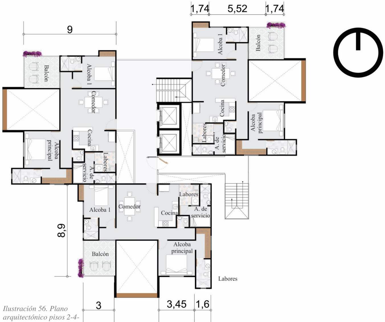
Ilustración 56. Plano arquitectónico pisos 2-4-6-8 y 10.
