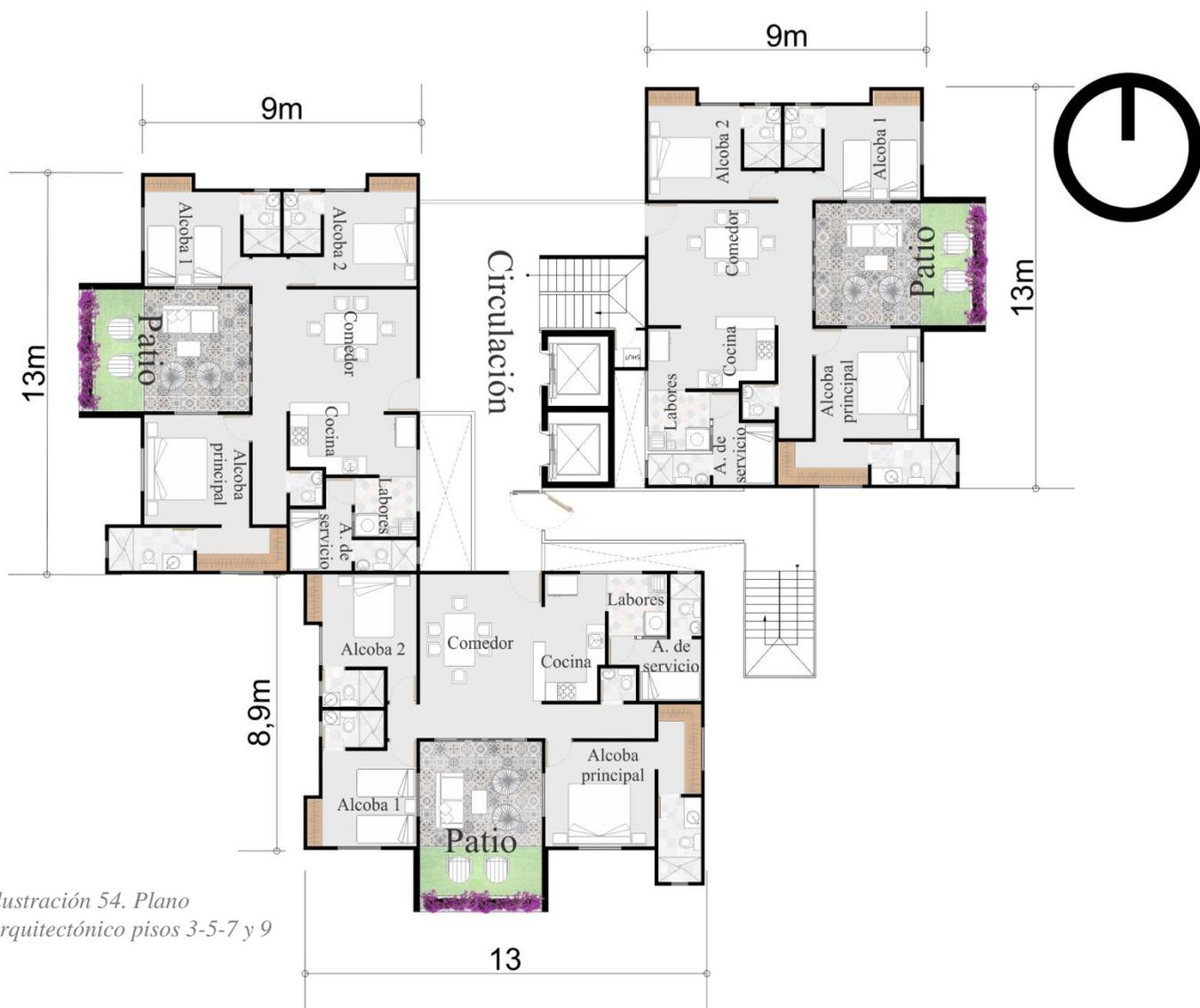
Ilustración 54. Plano arquitectónico pisos 3-5-7 y 9
