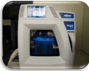
Figura 6: Equipo para la extracción asistida por microondas (MAE).
