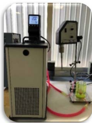
Figura 5: Equipo para la extracción asistida por ultrasonidos (UAE).
