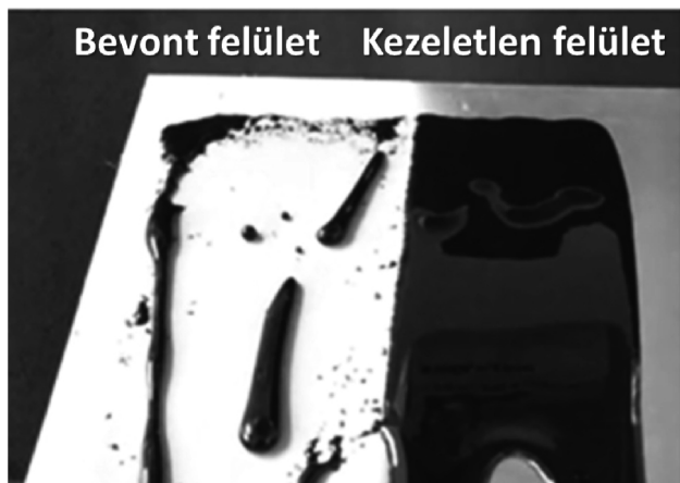
8. ábra. A szuperhidrofób és -oleofób bevonattal ellátott és a kiindulási rozsdamentes acél felületek nedvesedési tulajdonságai apoláros nyersolaj tesztfolyadék esetében
