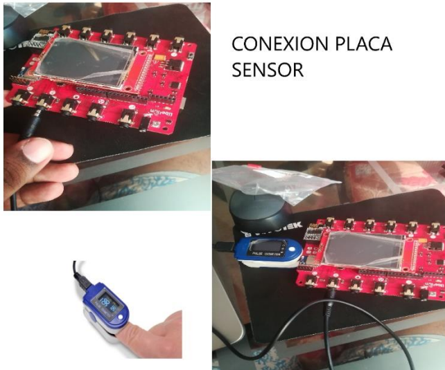
Figura 9. Conexion para prueba sensor oximetría ( Fuente propia)
