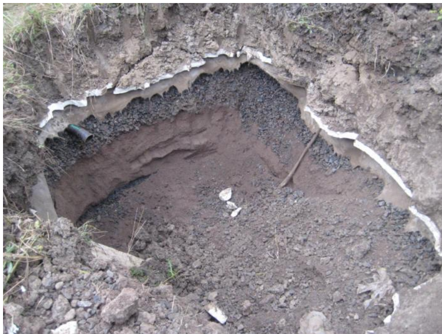
Kuva 14. Tammelan maasuodattamon näytteenottokuoppa
