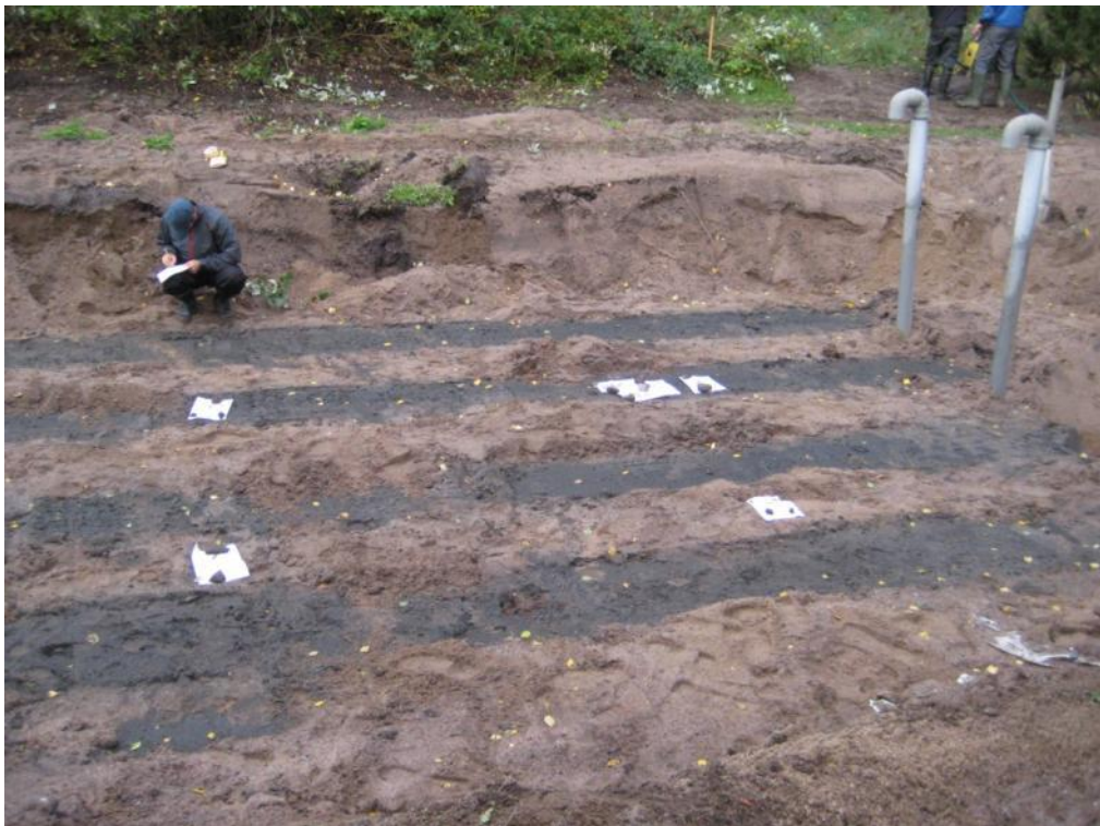
Raasepori 2. Kentän biokerros. Kuvasta näkyy hyvin, että jätevesi on jakautunut lähinnä imeytysmoduulien alla olleeseen maahan.
