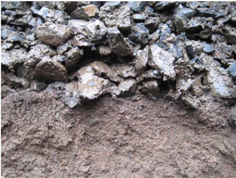
Tammela 2. Lähikuva biokerroksesta ja jakokerroksesta. Havaittavissa alle 5 cm paksu tummempi ja tiivimpi kerros imeytyspinnassa.
