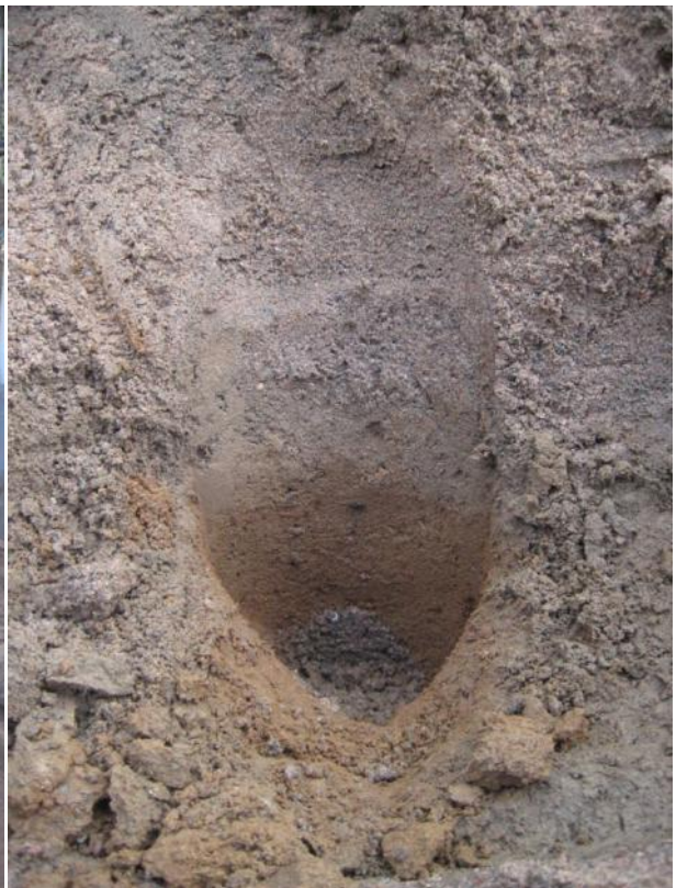
Raasepori 4 & 5. Vasemmalla kentän purkamista, näkyvissä vedellä täyttyneet tuuletusputket Fosfilt-hiekkakerroksen yläpinnalla. Oikealla lähikuva hiekan ja Fosfilt-hiekka-seoksen rajapinnasta, johon oli muodostunut rakenteeltaan tiiviimminkin tuntuinen tukkeumakerros.
