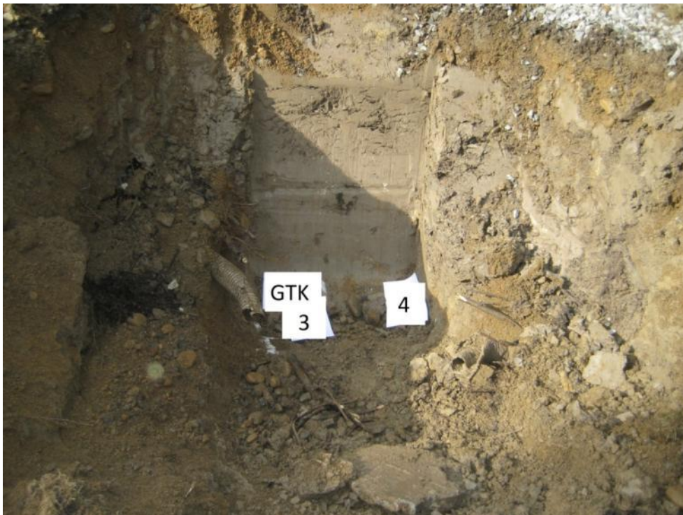
Akaa 2. Näytteenottokuopan pohja. Kuvaan merkitty kaksi näytteenottoa. Kuvassa nähtävissä maaperän savinen koostumus ja osa imeytyssorasta.
