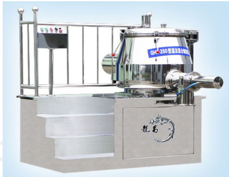
Figura 16. Granulador Húmedo Longchang con capacidad de 200 Kg.
