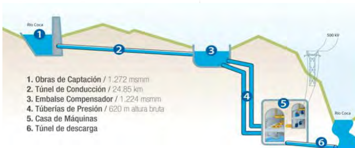
Figura 38. Ejemplo gráfico del funcionamiento de una central hidroeléctrica. Tomado de "Coca Codo Sinclair: Proyectos de generación", por Ministerio de Electricidad y Energía Renovable (MEER), 2016. Recuperado de http://www.energia.gob.ec/coca-codo-sinclair/
