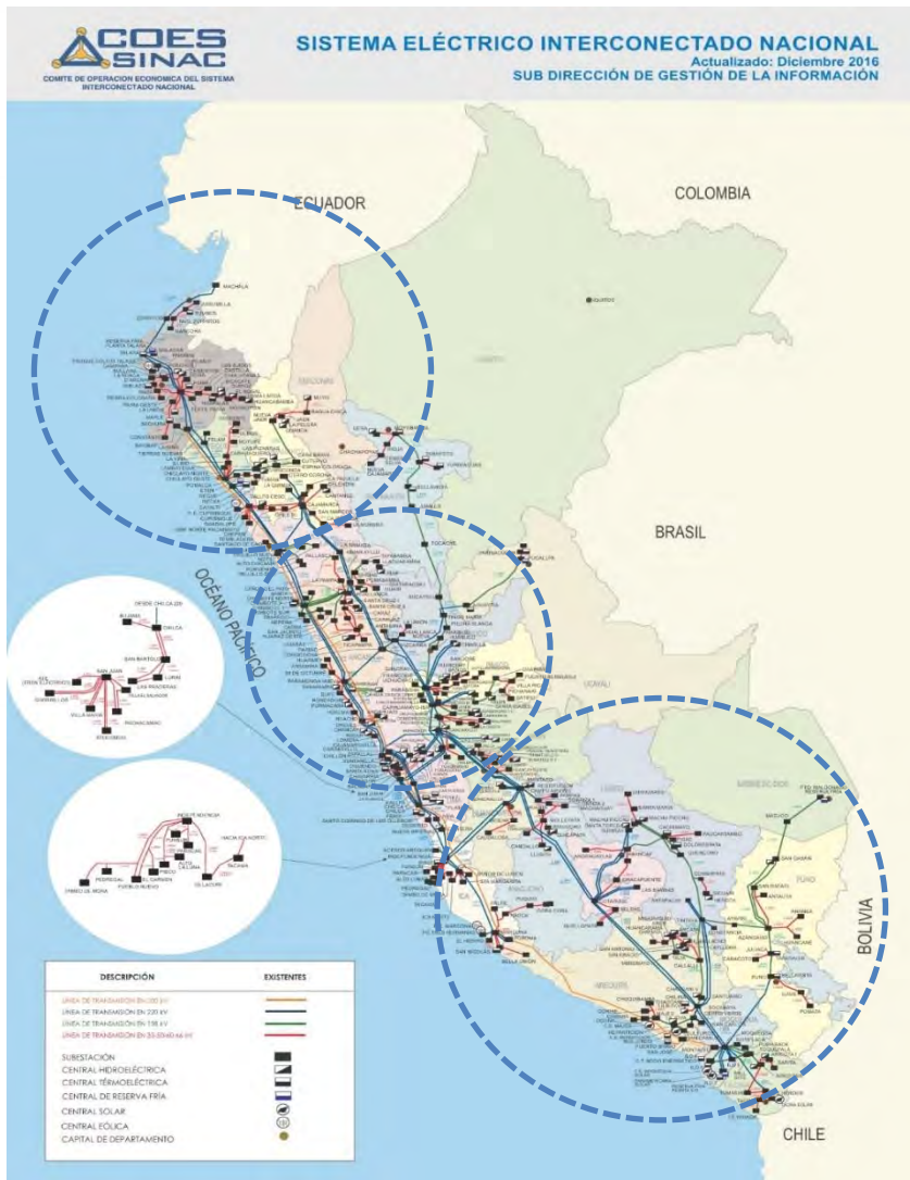
Figura 11. Despliegue del SEIN a fines del 2016, dividido por sus tres áreas de distribución. Tomado de “Sistema Eléctrico Interconectado Nacional a diciembre del 2016”, por Comité de Operación Económica del Sistema Interconectado Nacional (COES SINAC), 2017a. Recuperado de http://www.coes.org.pe/Portal/Publicaciones/Estadisticas/
