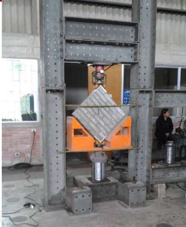
Fig.7.3 Dispositivos utilizados en el ensayo de muretes a compresión
