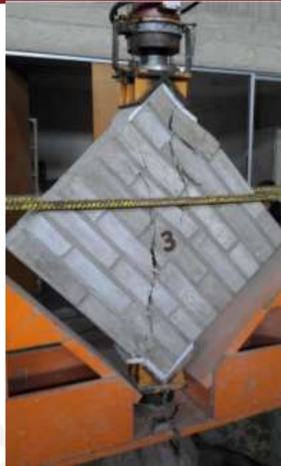
Fig.7.6 Formas de falla de murete M3
