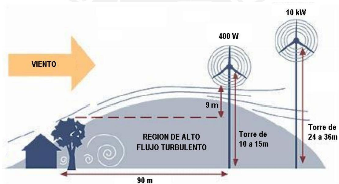
Fig. 1.11: Recomendaciones para la instalación de aerogeneradores luego de obstáculos
