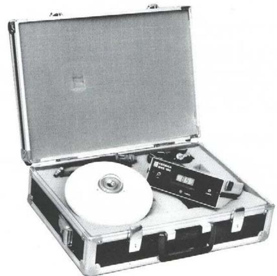
Fig. 2.7: Piranómetro con registrador
