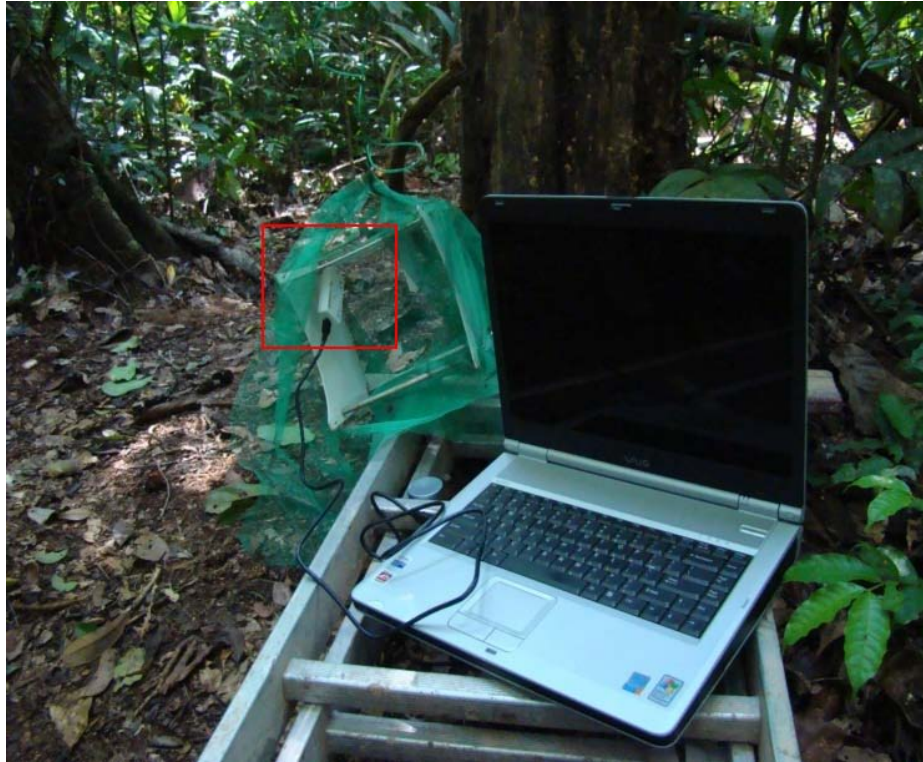
Figura 24. Descarga de datos del sensor de temperatura y humedad en campo. Se transportó al área de monitoreo una computadora para descargar directamente en campo los datos obtenidos por los sensores, enmarcado en rojo, de esta manera los sensores pudieron mantenerse en el área de estudio permanentemente.
