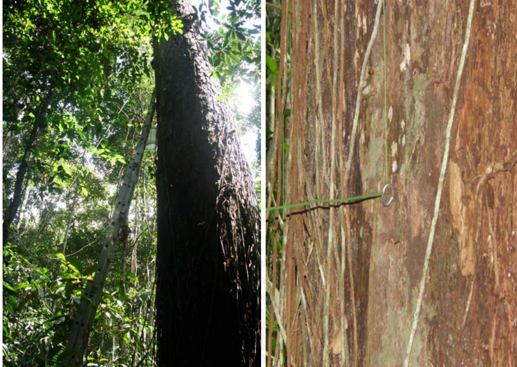
Figura 26. Instalación del nuevo sistema de muestreo de BVOCs. Izquierda: árbol sostén del sistema soporte con la escalera para el montaje. Derecha: detalle de armella fijada al tronco del árbol sostén y cable acerado de color verde.
