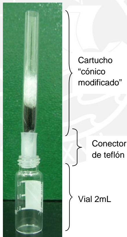
Figura 5. Ensamble cartucho/teflón/vial. Se conectó un cartucho “cónico modificado” a un vial de 2mL a través de un tubo conector de teflón para eluir con 400 \mu L de solvente. Este sistema se utilizó tanto para los experimentos de elución por centrifugación como por reflujo criogénico.
