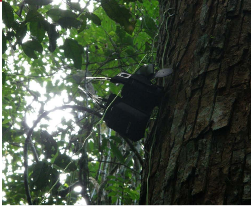
Figura 28. Captura de BVOCs en campo utilizando Carbograph 1. El monitoreo se realizó a una altura de 6 m mediante un sistema de elevación por cables. Los cartuchos fueron orientados en dirección contraria al árbol sostén.
