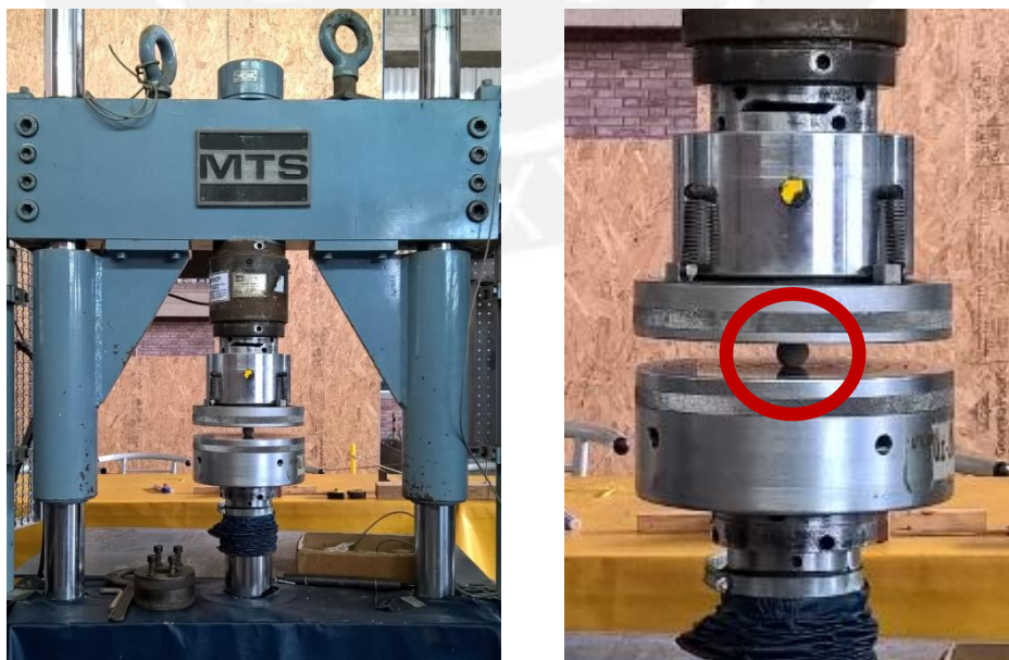
FIGURA 24: Máquina Universal donde se ensayan otro tipo de probetas de distintos materiales en el Laboratorio de Estructuras-PUCP
