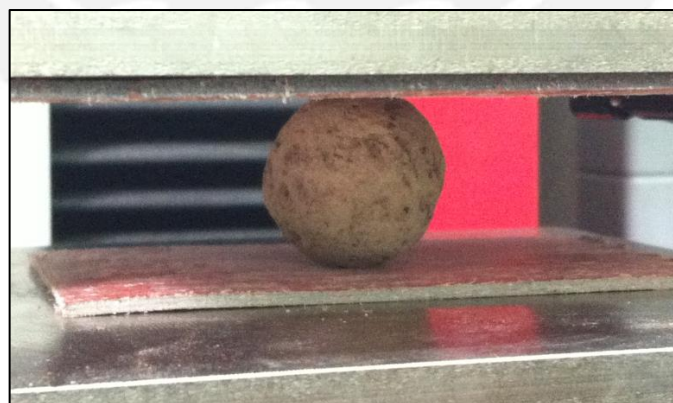
FIGURA 51: Detalle del Capping de asbesto de 1.5mm de espesor.
