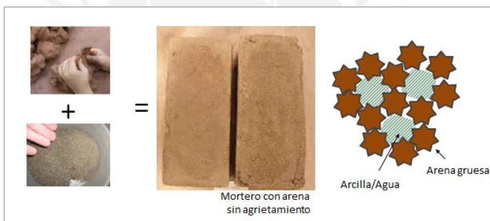
FIGURA 42: Formación de un esqueleto granular formado por los granos de arena gruesa (Vargas, J. 2013)
