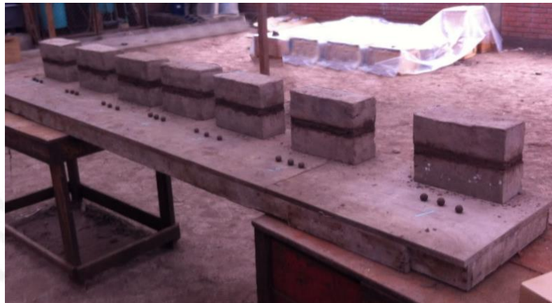
FIGURA 43: Fabricación de especímenes para el ensayo de Control de Fisuras.
