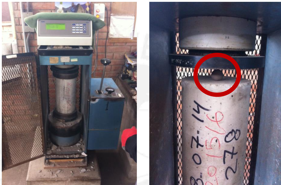
FIGURA 23: Máquina compresora de probetas de concreto en el Laboratorio de Estructuras-PUCP
