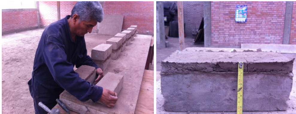
FIGURA 45: Destape de los especímenes, pasadas 48 horas de secado y verificación de espesor de 20 mm.
