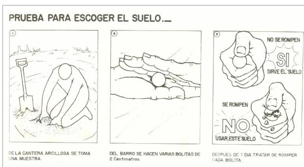
FIGURA 14: Gráficas de la prueba cualitativa para determinar la presencia de arcilla tomadas de los manuales “Nuevas Casas Resistentes de Adobe”
