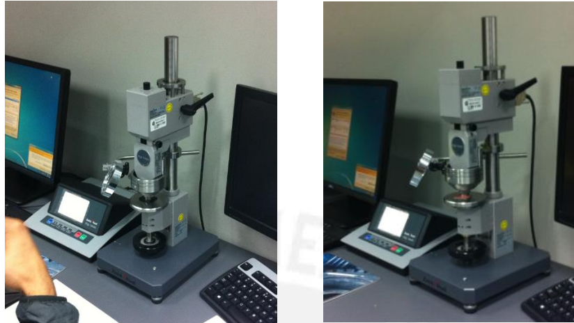
FIGURA 33: Ensayo de dureza de los materiales Jebe y Asbesto.
