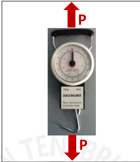
FIGURA 17: Dinamómetro mecánico que funciona a tracción.
