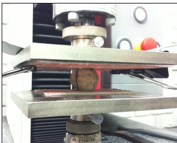
FIGURA 52: Detalle de la falla de las esferas ensayadas a compresión diametral
