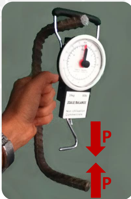
FIGURA 18: Adaptación de una varilla de acero corrugado de \frac{1}{2} pulgada de diámetro para poder medir fuerzas en compresión.
