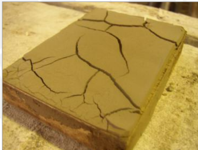
FIGURA 5: Fisuras de la arcilla al secarse.
