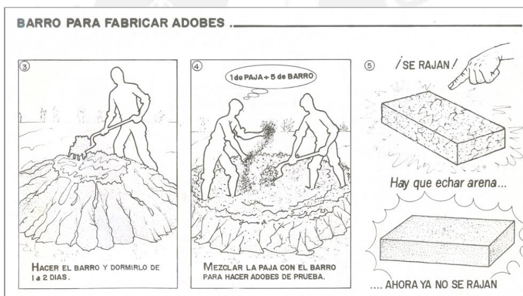
FIGURA 15: Indicación de agregar paja y/o arena gruesa a la mezcla para evitar fisuras tomadas de los manuales “Nuevas Casas Resistentes de Adobe”
