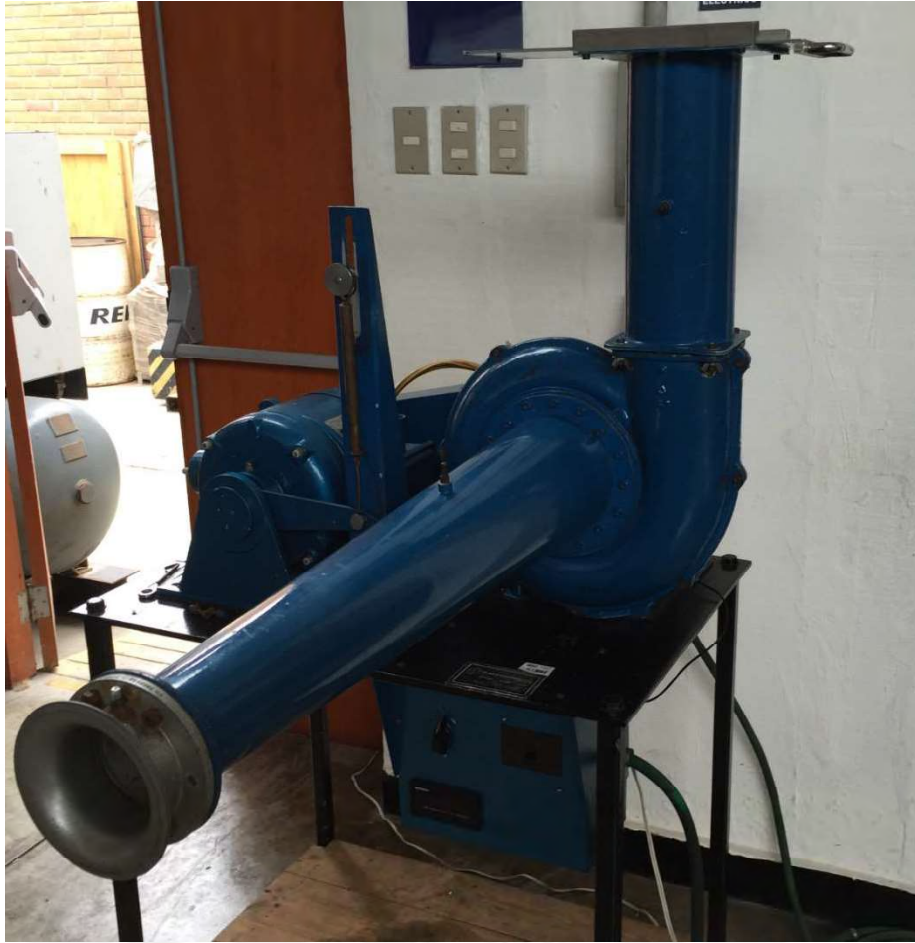
Figura 3.17 – Imagen del ventilador centrífugo del laboratorio.
