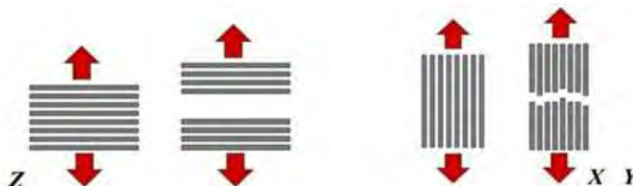
Figura 1.6 – Esquema de la ruptura perpendicular al eje y paralelo al eje de los filamentos. [12]
