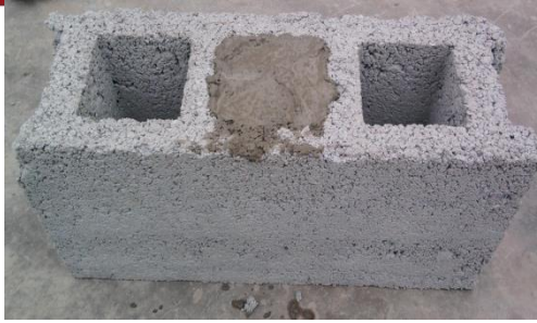
Fig 3-7. Relleno al 33% de alveolos.
