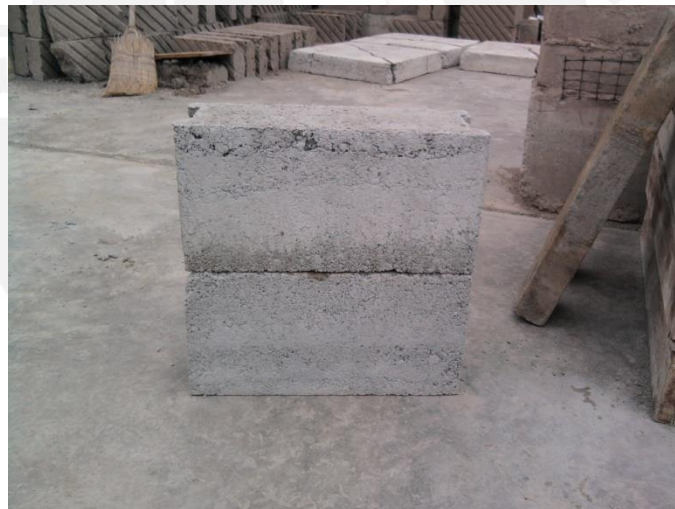
Fig 4-7. Bloques colocados uno encima del otro verificando su trabajabilidad.
