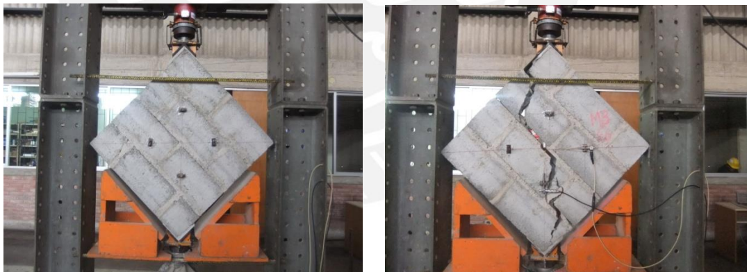
Fig. 4-28. Murete en la máquina de ensayo bajo compresión diagonal
