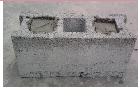
Fig 3-8. Relleno al 66% de alveolos.
