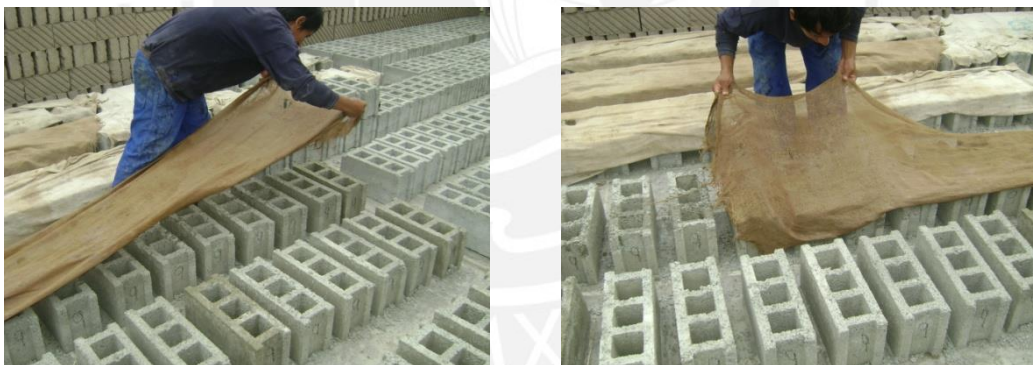
Fig 4-11. Curado de los bloques mediante tejido de yute.
