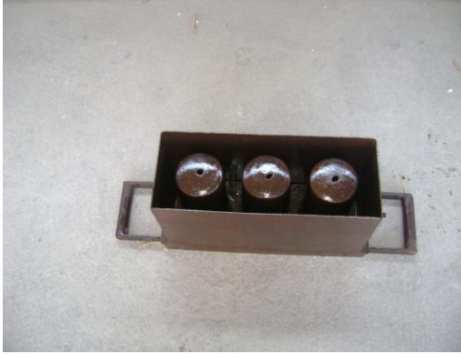
Fig 3-3. Molde con huecos circulares.
