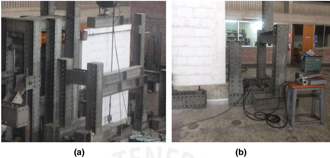
Fig. 5-21. (a) Celda de carga horizontal. (b) Celda de carga vertical.
