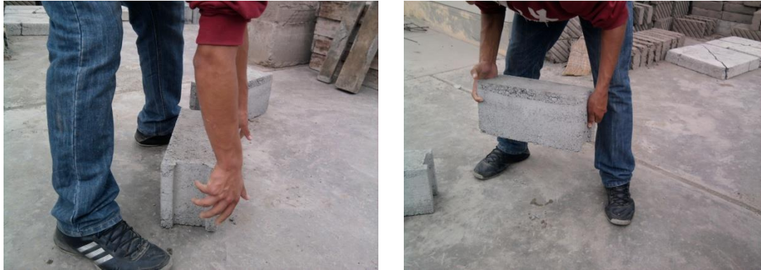
Fig 4-6. Alzado del bloque con los alveolos hacia abajo.
