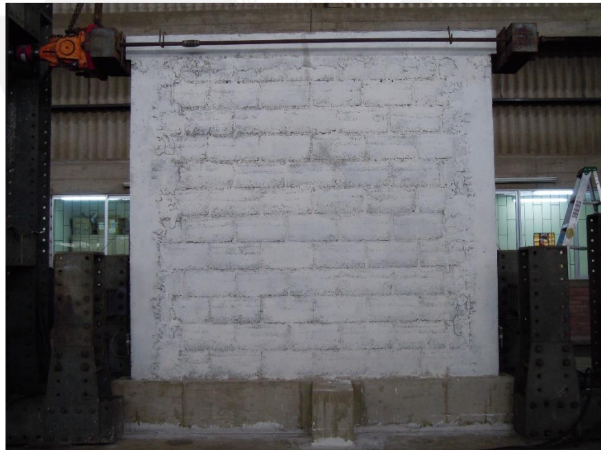
Fig. 5-18. Muro M1-33 instalado en la máquina de ensayo.
