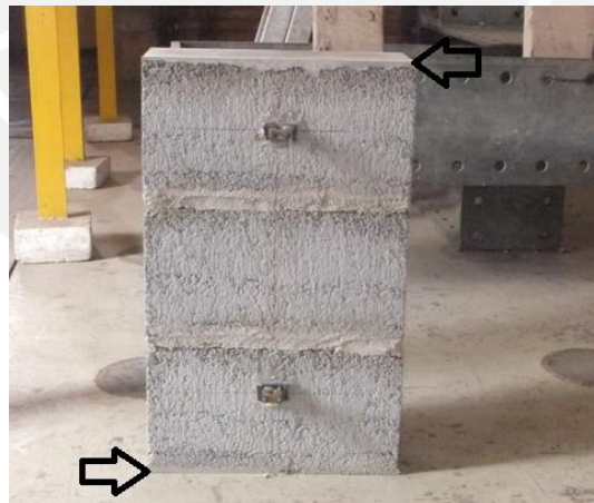
Fig 4-9. Colocación del capping para uniformizar esfuerzos en la sección.
