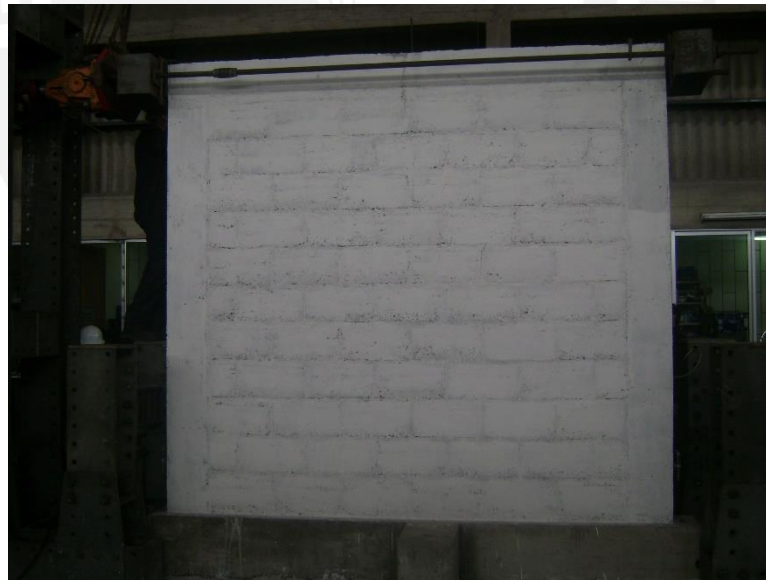
Fig. 5-22. Muro conectado a las celdas de carga.
