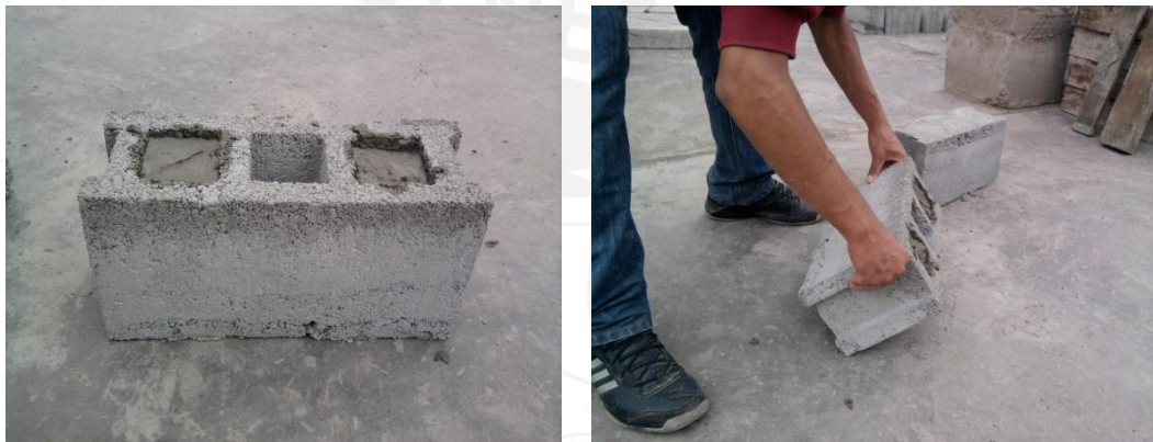
Fig 4-4. Agarre con las dos manos fuertemente los extremos del bloque relleno.
