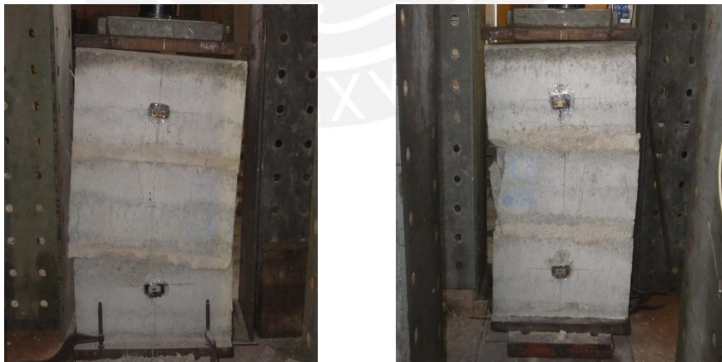
Fig. 4-15. Deslizamiento entre bloques al 66% de alveolos rellenos
