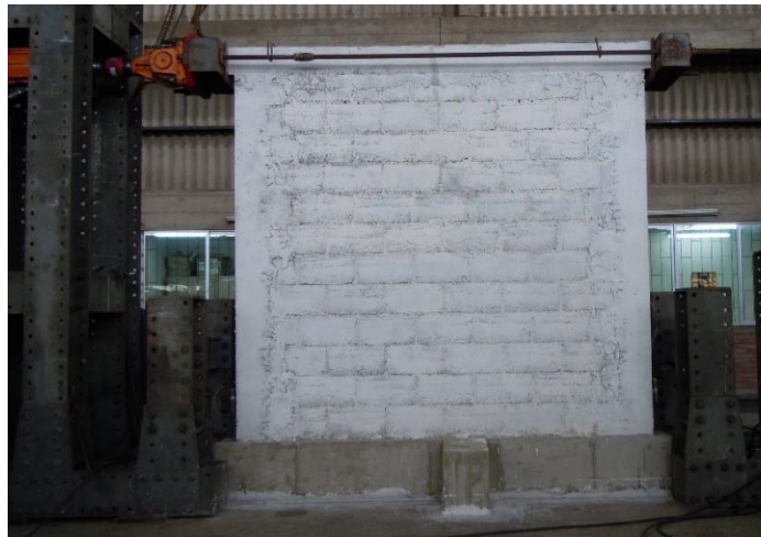
Fig. 5-25. Fase 1: Comportamiento elástico.
