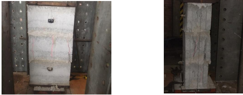
Fig. 4-14. Falla vertical en bloque al 33% de alveolos rellenos
