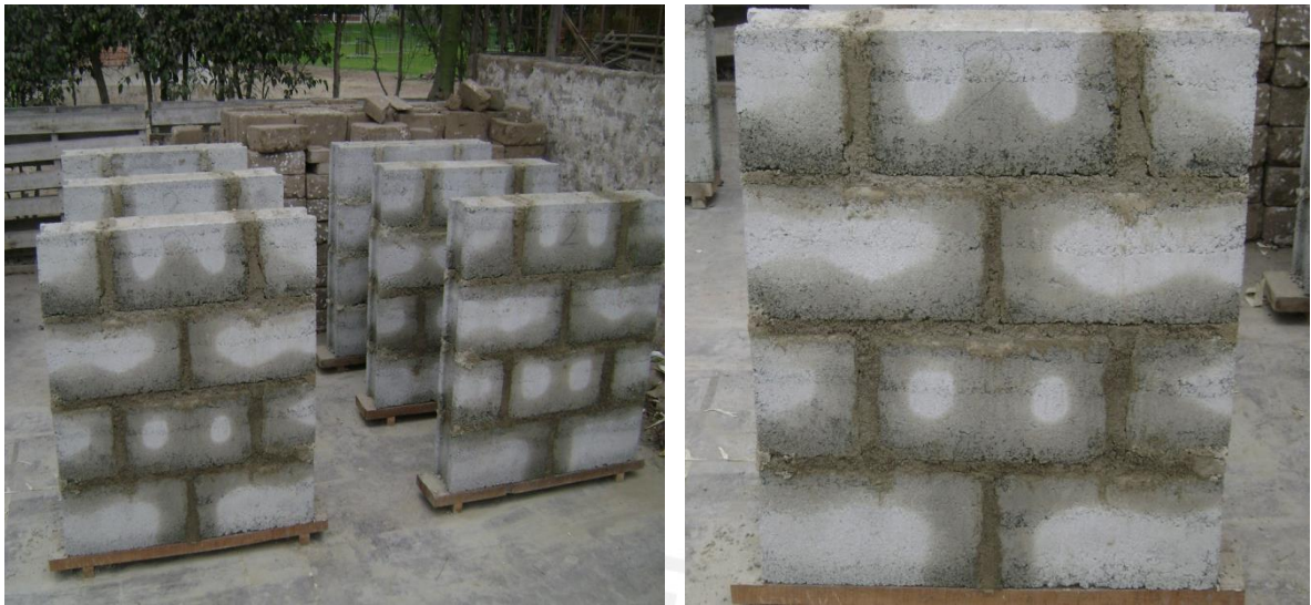
Fig. 4-22. Muretes construidos al 33% y 66%
