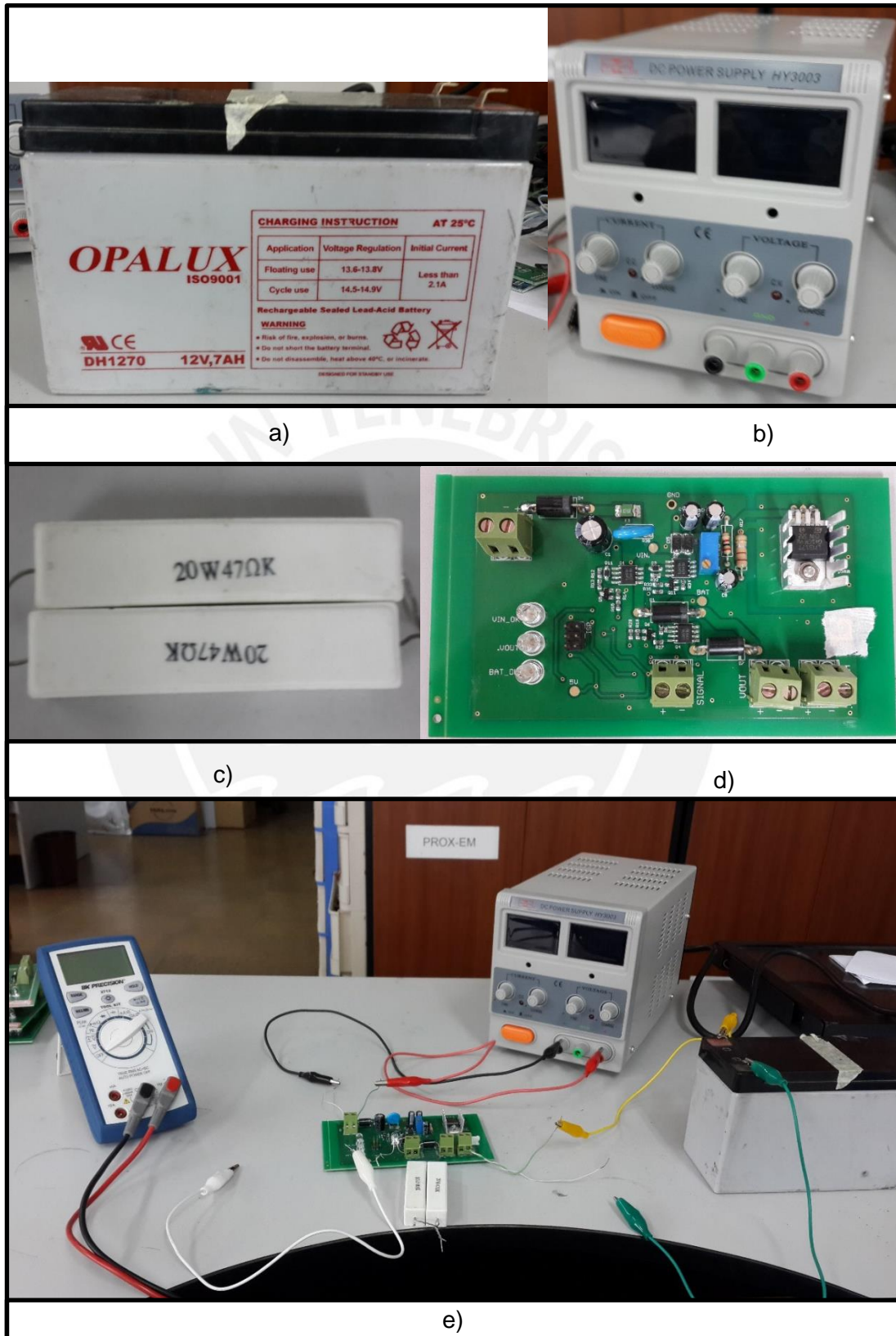
Figura 3.2 a) Batería OPALUX, b) Fuente regulable de voltaje, c) Resistencias de potencia de 47 ohms, d) Vista superior de la tarjeta a probar, e) Colocación de equipos para la prueba Fuente: Propia
