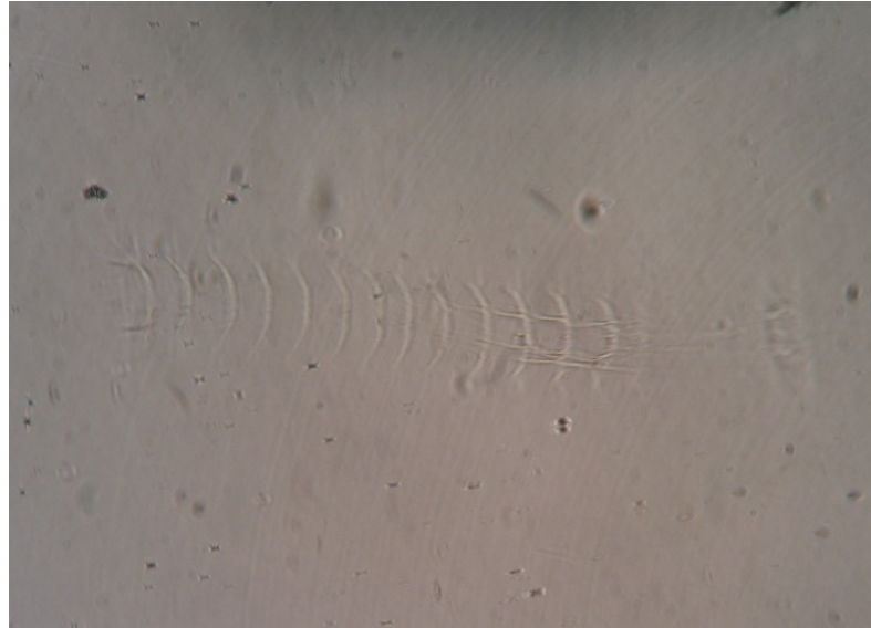
Figura 2.12: Huellas de partículas \alpha formadas con incidencia tangencial. Se aprecian los frentes de ondas generados por el paso del haz primario. (Microscopio con alcance 20x)
