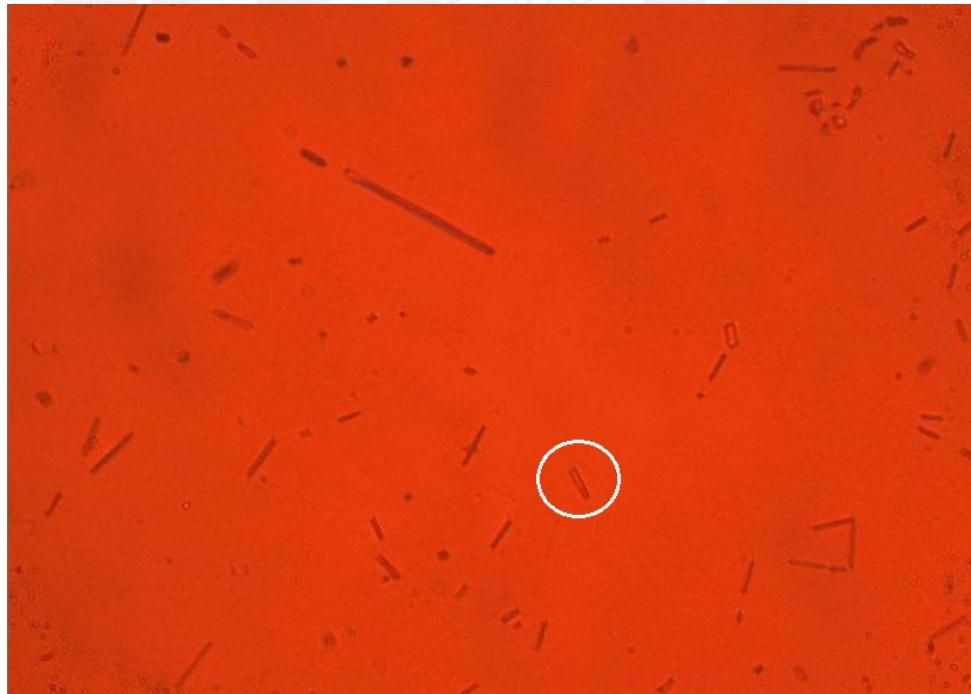
Figura 2.16: Huellas de partículas \alpha formadas con incidencia tangencial. (Microscopio con alcance 20x)
