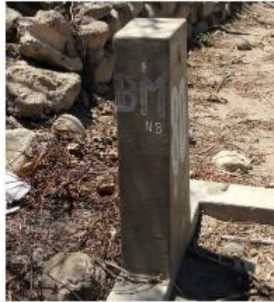
Figura 36: BM número 80, que fue tomado como punto de partida para el análisis.
