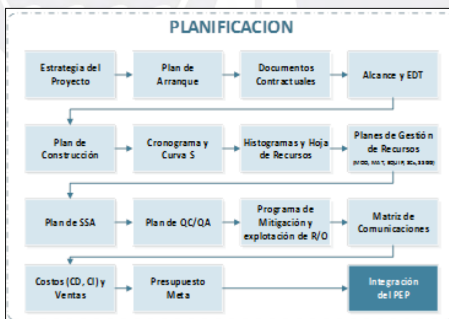
Figura 44. Planificación de la construcción.
