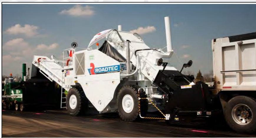
Figura 26. Preparación de material mientras se alimenta con la materia prima. Tomado de SB-1500e/ex Shuttle Buggy , por Roadtec, s.f. ( https://www.roadtec.com/products/material-transfer-vehicles/sb-1500 ).
