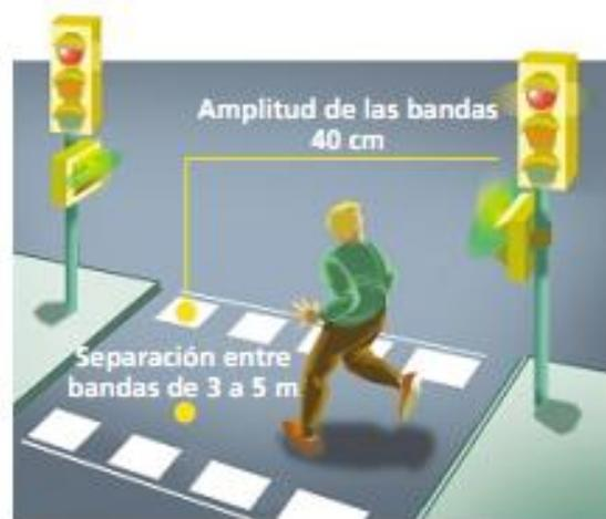
**Figura 22: Propuesta del RACC, para cruces, en intersecciones controladas por semáforos.**
