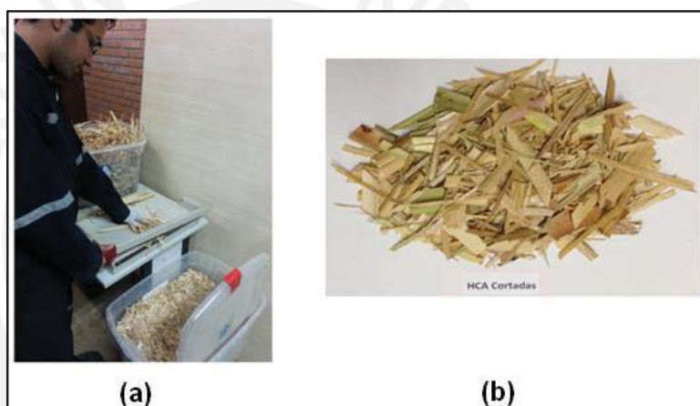
Ilustración 3. 6 (a) Proceso de trozado de las HCA, (b) Tamaño de HCA cortadas.
