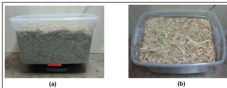
Ilustración 3. 7 (a) y (b) Recipiente para el cálculo de la densidad aparente.
