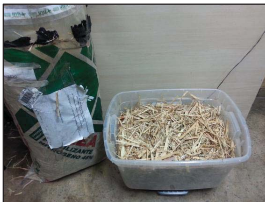
Ilustración 3. 5 Recipiente para el cálculo de la densidad aparente.
