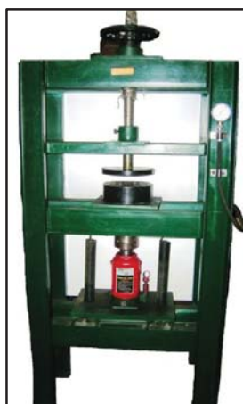
Ilustración 2. 5 Briqueteadora con gata hidráulica y tornillo de potencia. Fuente: Fotografía tomada en el laboratorio Carbón-Biomasa PUCP 2014.
