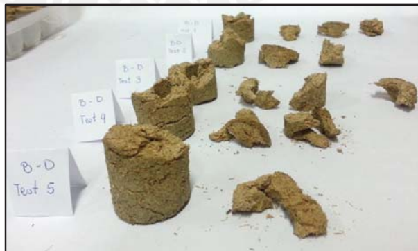
Ilustración 4. 6 Ensayo de impacto Formulación B-D.
