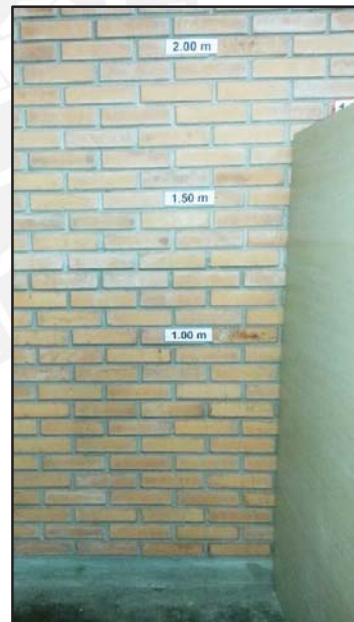
Ilustración 4. 5 Altura de lanzamiento de las briquetas 2m.
