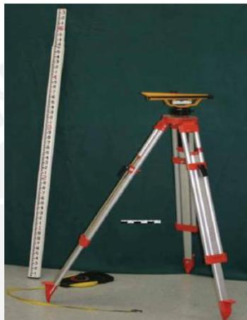
Figura 13: Mira y nivel usados para determinar el IRI
