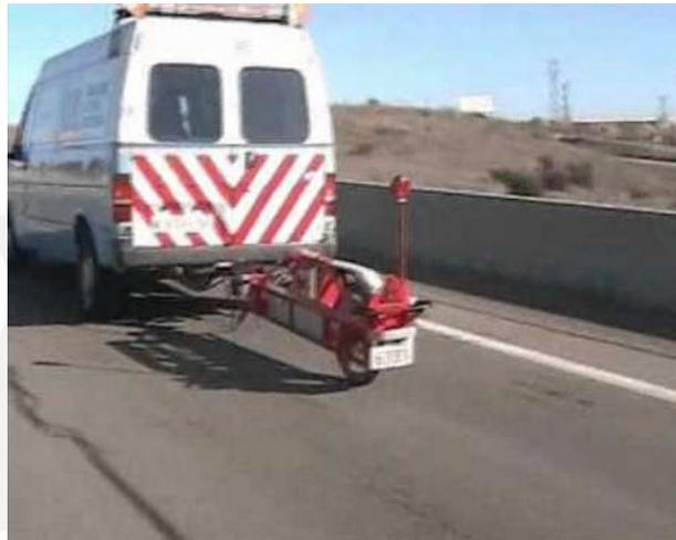
Figura 11: Perfilómetro APL
