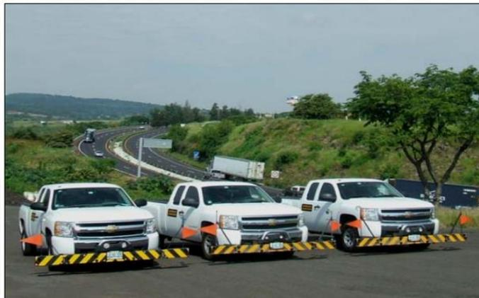
Figura 9: Perfilómetro inercial R-II
