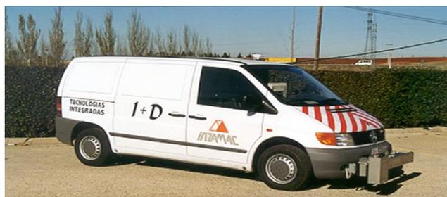
Figura 17: Perfilómetro inercial
