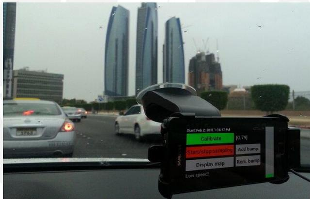
Figura 12: Teléfono celular con Roadroid con la base instalada en la ventanilla delantera de un vehículo para realizar la medición del IRI
