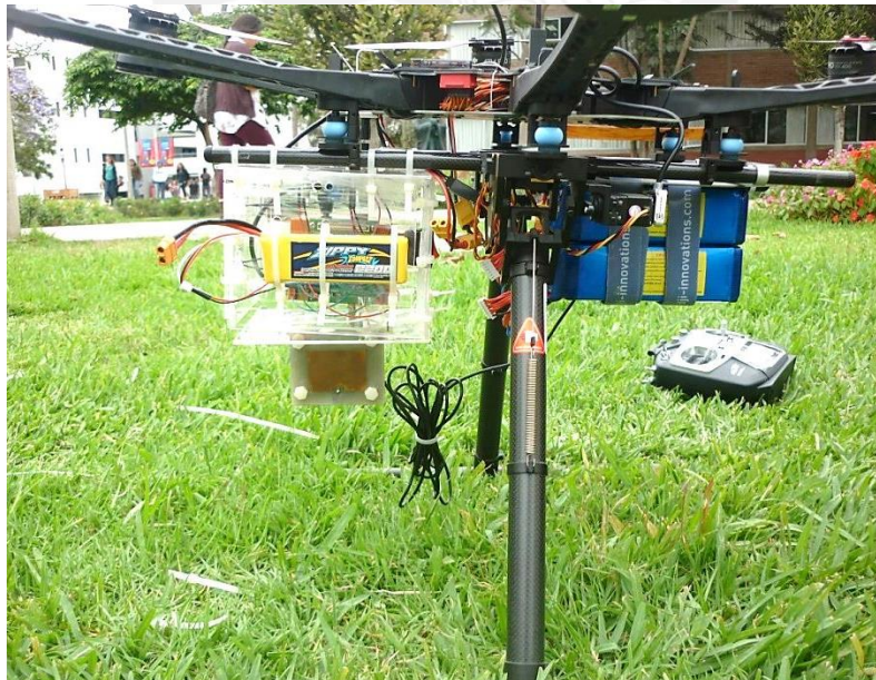
Figura 4.5: Imagen del sistema montado en el drone con la antena de 1900 MHz
