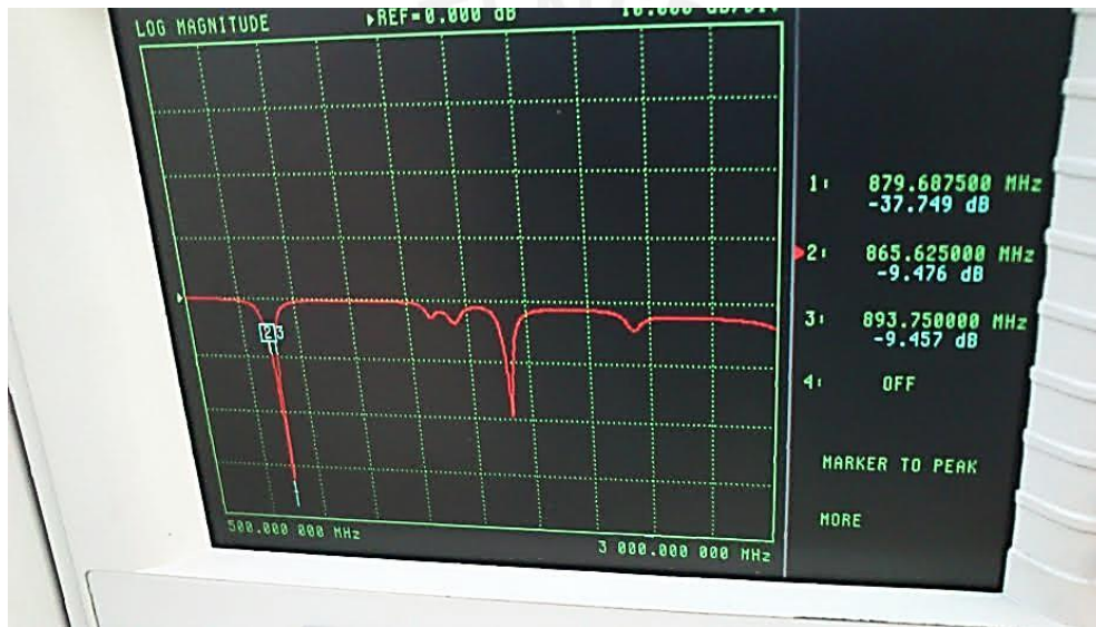
Figura 3.14: Prueba de la antena microstrip para la banda de retorno de 850 MHz en el VNA
