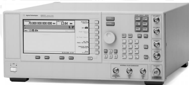
Figura 3.4: Generador de señal analógica de microondas E8257D
