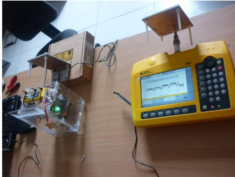
Figura 4.11: Prueba de ambos sistema en un punto fijo utilizando la antena de retorno de 850 MHz Fuente: Elaboración propia
