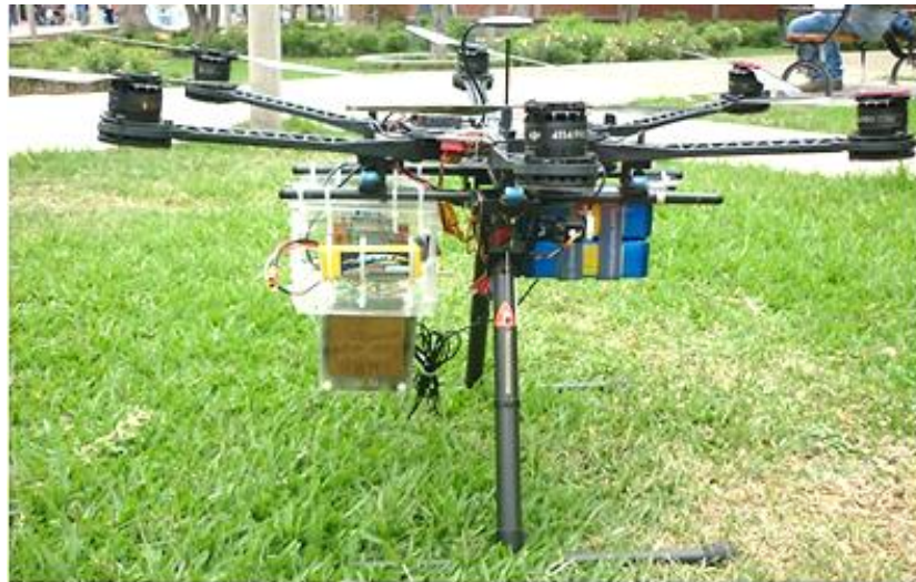
Figura 4.6: Imagen del sistema montado en el drone con la antena de 850 MHz
