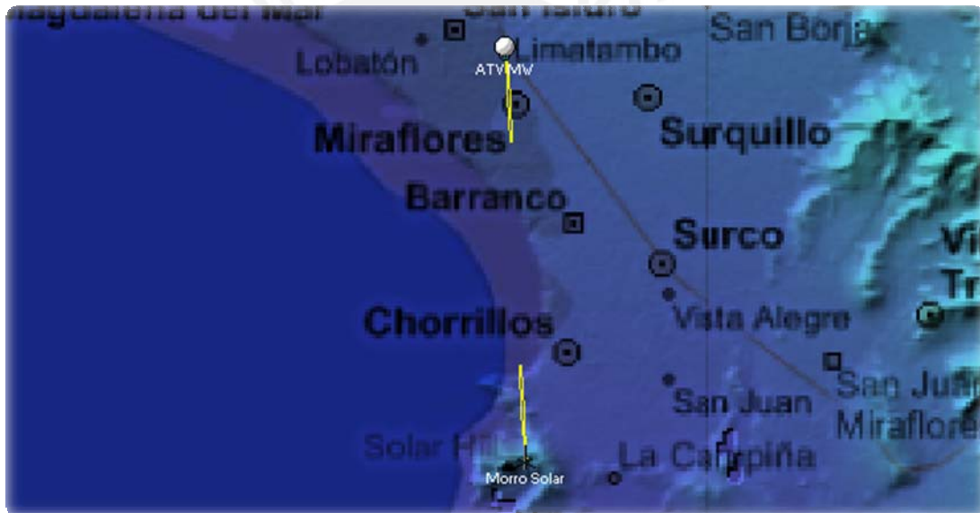
Figura 3.5 – Alineación de las antenas para enlace de microondas (RadioMobile)
