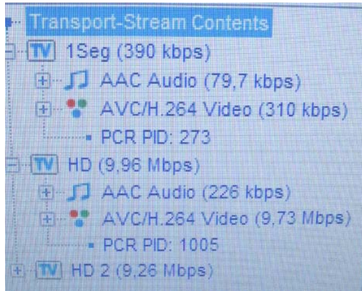
Figura 1.13 – Emulación de señal SBTVD (2 HD + 1 OneSeg) Instalaciones de ATV, Andina de Radiodifusión
