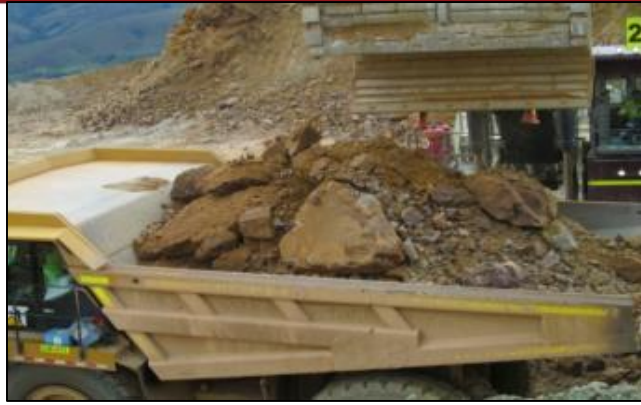
Figura 32. Material producto de la voladura cargado en tolva. (Elaboración propia)
