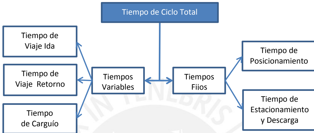
Figura 1. Clasificación del tiempo del ciclo de carga y acarreo. (Elaboración propia)
