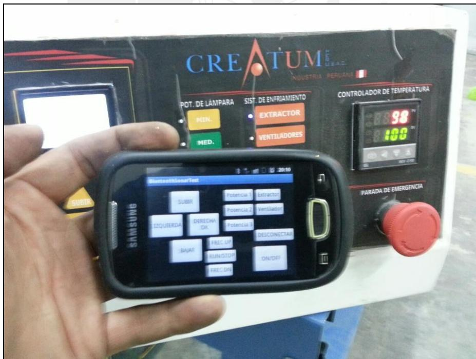
Figura 24. Aplicación java controlando el tablero automatizado.
