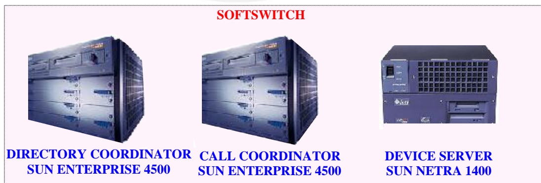
Figura 2.5 Elementos Componentes del Softswitch (Fuente: http://www.sun.com/ )
