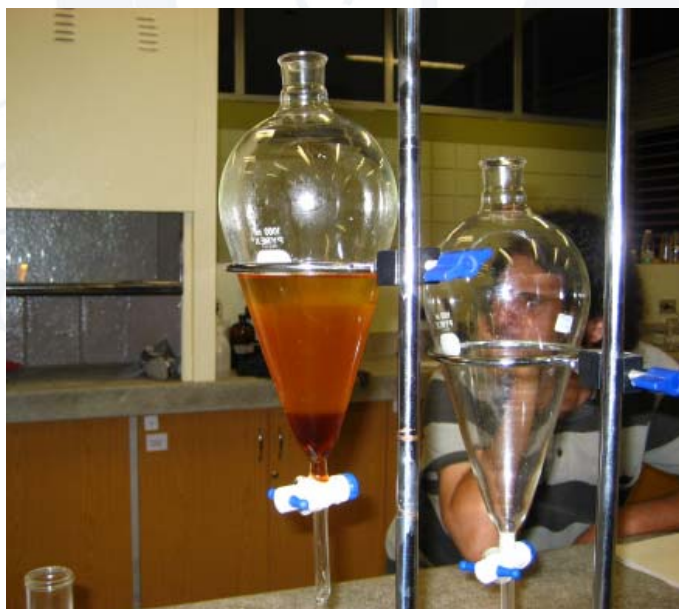
Figura 36. Separación de la glicerina del biodiesel por decantación
