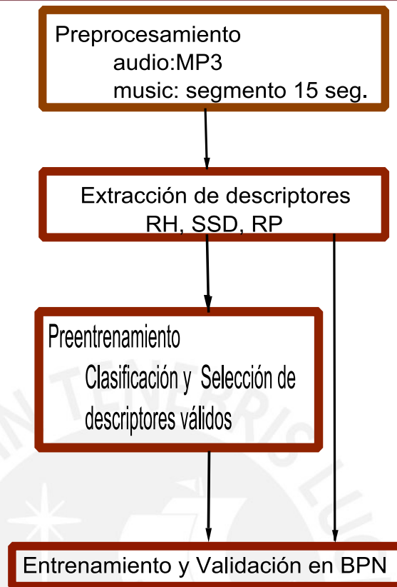
Figura 0.1: Estructura general del sistema propuesto.
