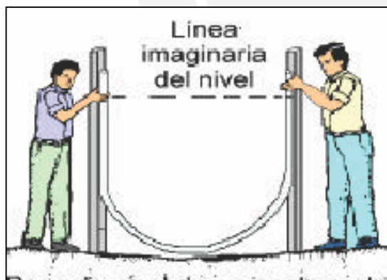
Fig. 7.11 Nivelación del terreno (SENA 2001)
