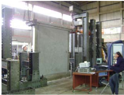
Figura 7.1 Actuador dinámico y distribución de LVDT
