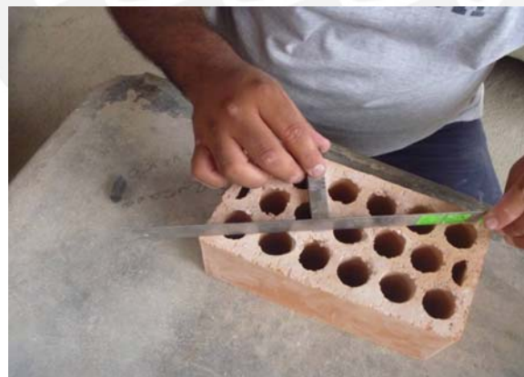
Figura 3.3 Determinación del Alabeo en los ladrillos
