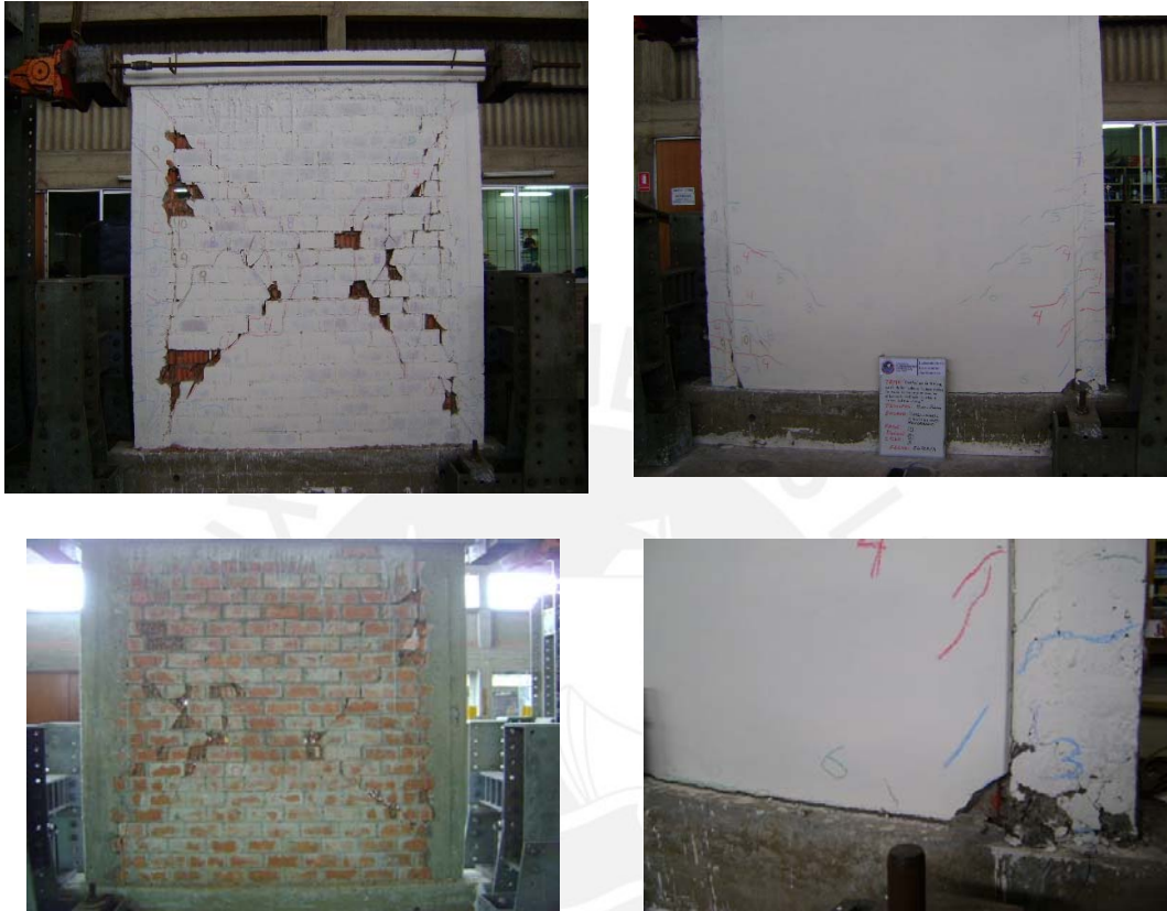
Figura 7.2 Estado final de los muros M1 (izquierda) y M2 (derecha), después de la fase armónica ( D1 = 15\text{mm} , f = 2\text{ Hz} )
