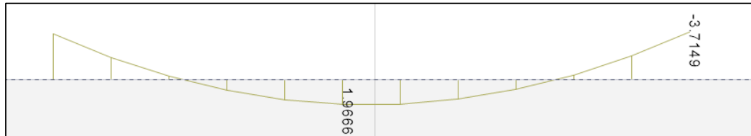
Figura N°27: Diagrama de momentos flector en servicio de la viga VT-02
