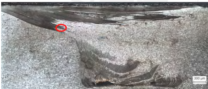
(d) S6 (2000 rpm; 40 mm/min)
