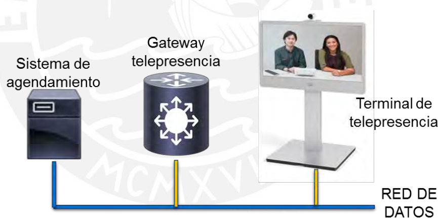
Figura 2-3: Esquema lógico del sistema de telepresencia [fuente propia]
