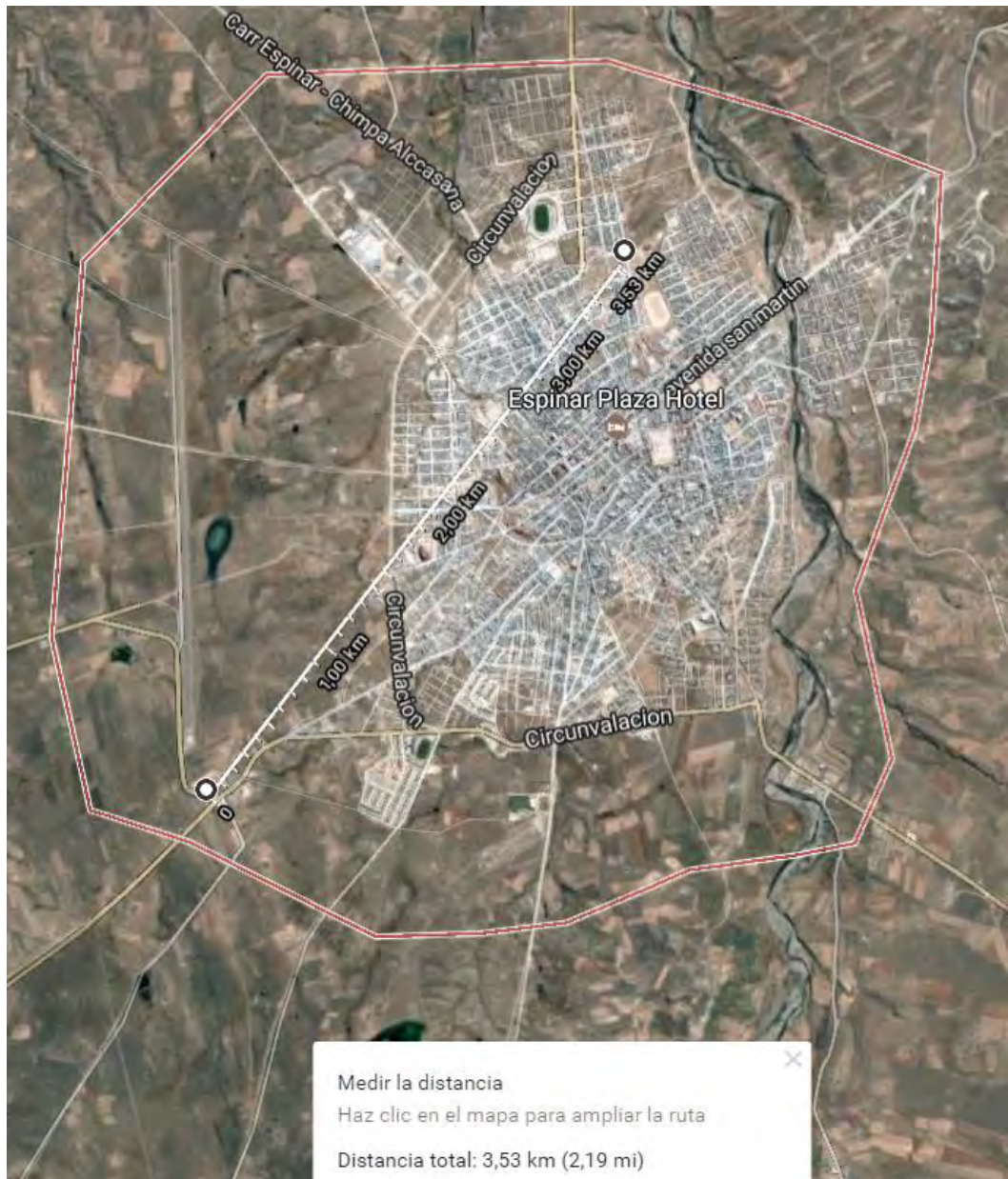
Figura 3-21: Rango de cobertura para radio portátil en el distrito de Espinar de 3.53 km en lugar más alejado [50]
