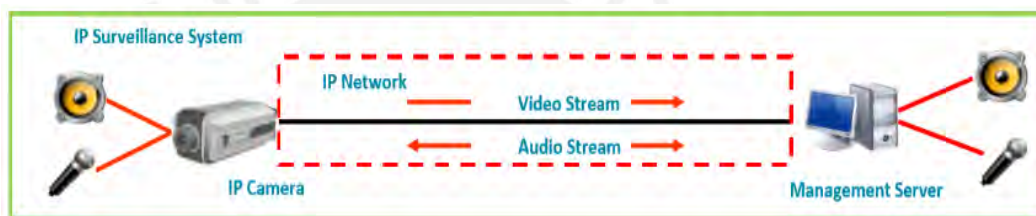
Figura 3-4: Transmisión de audio y video en red IP [42]
