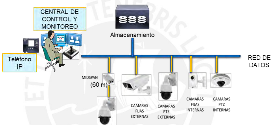
Figura 2-2: Esquema lógico del sistema de video vigilancia [fuente propia]
