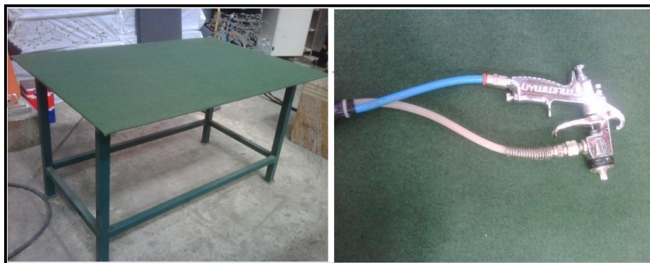
Figura 81. Mesa especial para la operación de “pegado” y aspersor de pegamento Elaboración propia
