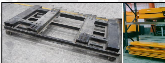
Figura 82. Móvil mecánico para el traslado y almacenamiento en racks Elaboración propia
