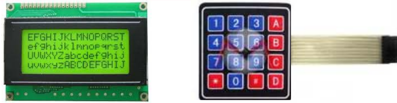
Figura 3.3: Pantalla LCD y teclado matricial
