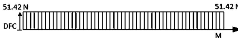
Figura 3.34 Diagrama de Fuerza Cortante – Perfil “B”
