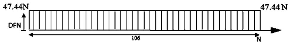
Figura 3.41 Diagrama de Fuerza Normal – Sección Perfil “C”
