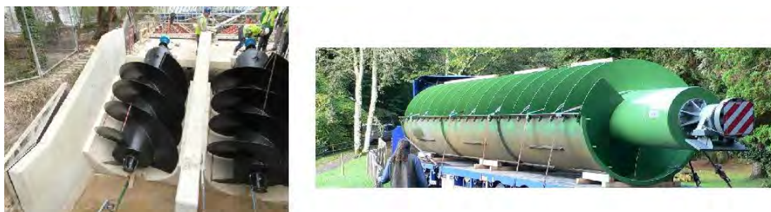
Fig.1.10: Cama de hormigón y cama de acero de un tornillo de Arquímedes. (Bedford, 2012) - (RenewableFirst, 2006)
