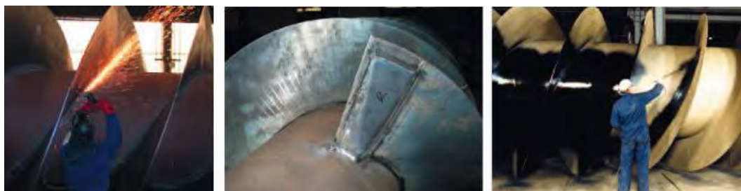
Fig.1.9: Proceso de fabricación de las hélices de un Tornillo de Arquímedes. (Landustrie, 2012)
