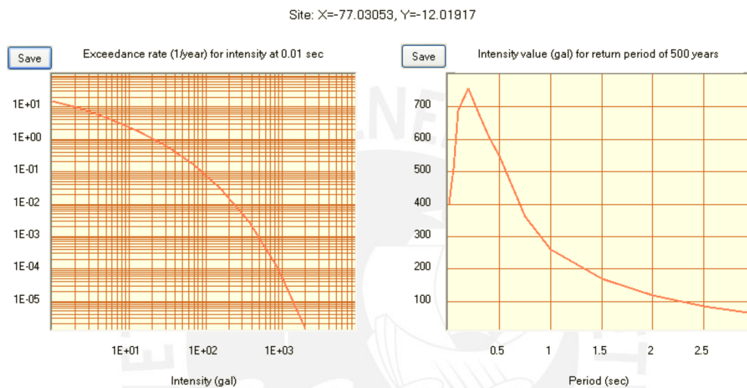
Figura 3.9. Tasa de excedencia de intensidades y espectro de peligro uniforme para el centro de la Ciudad de Lima calculados con el programa CRISIS2007 (Santa-Cruz, 2013)
