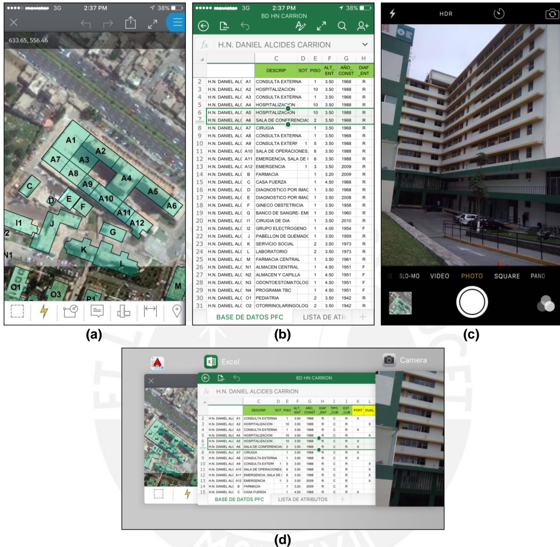
Figura 3.14. Recolección de datos de campo utilizando dispositivos electrónicos: (a) georeferenciación, (b) base de datos, (c) fotografía del hospital, (d) entorno multitarea
