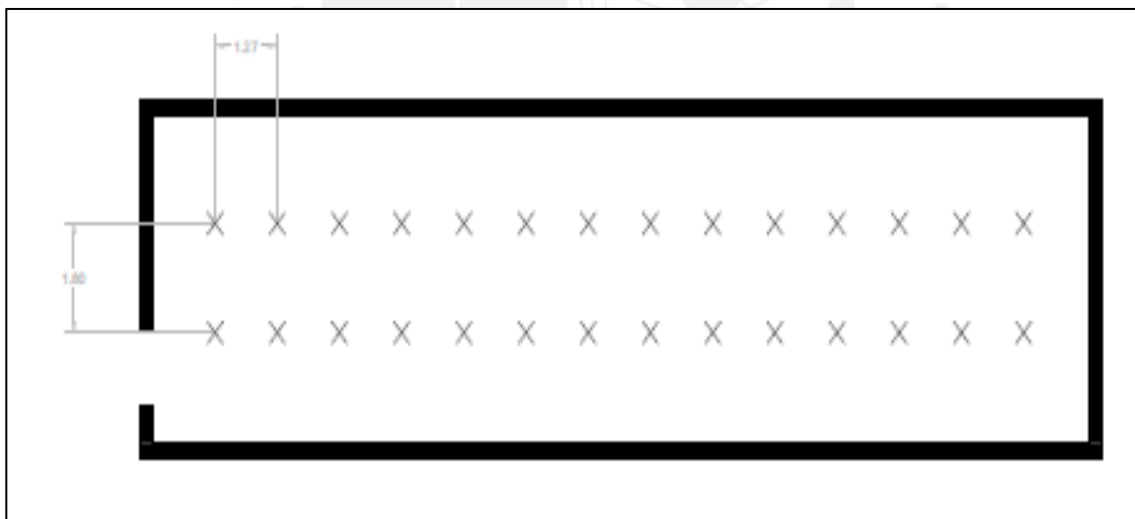
Figura 3.10 Distribución LEDs almacén segundo piso
