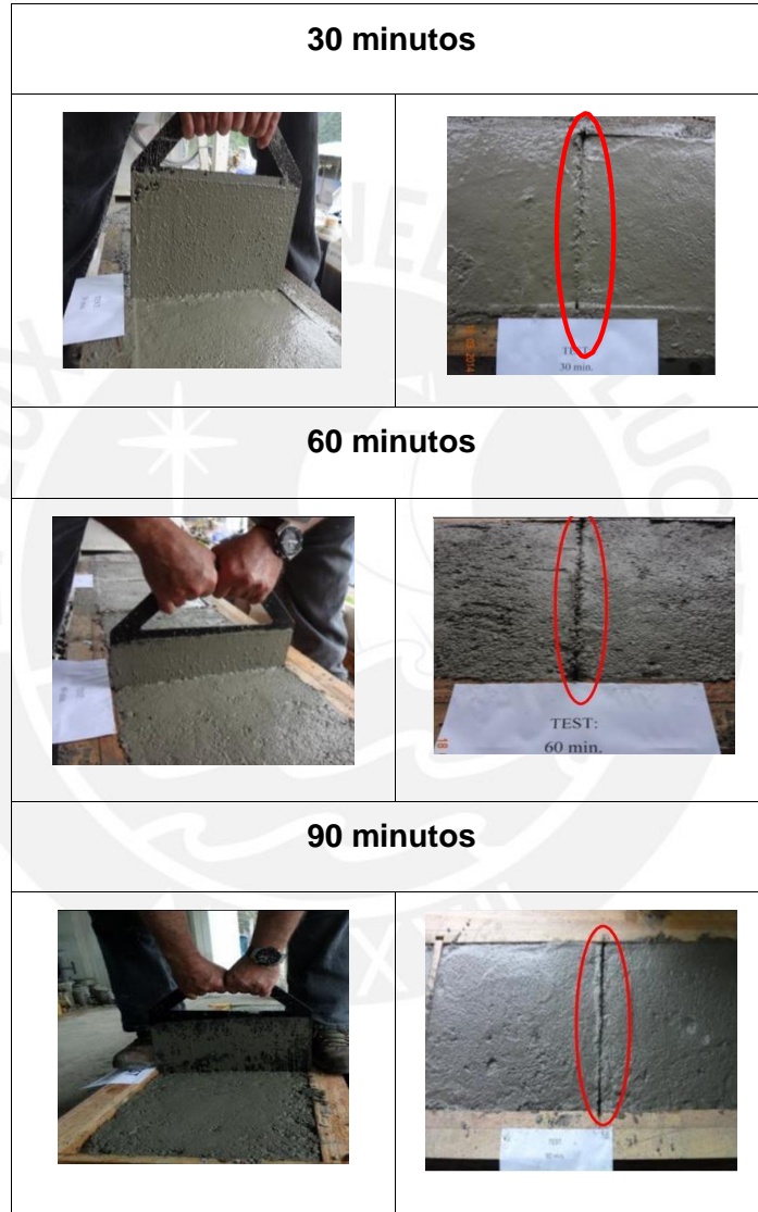
Figura 8. Retiro de plancha para el primer ensayo
