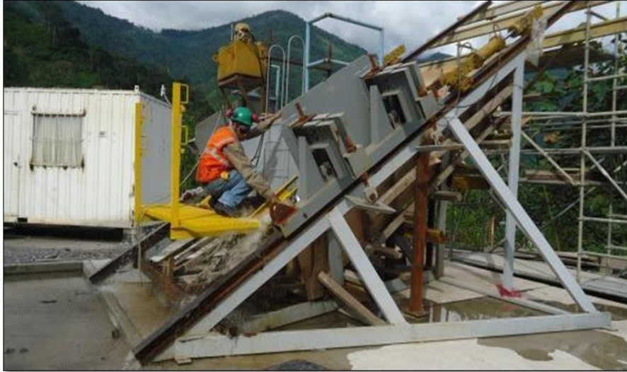
Figura 16. Modelo reducido de la regla deslizante (2.44 m ancho x 0.80 m alto x 3.00 m largo) – Primera prueba
