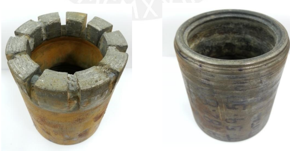
Figura 1.2. Broca con canales de refrigeración obstaculizados y broca fundida.
