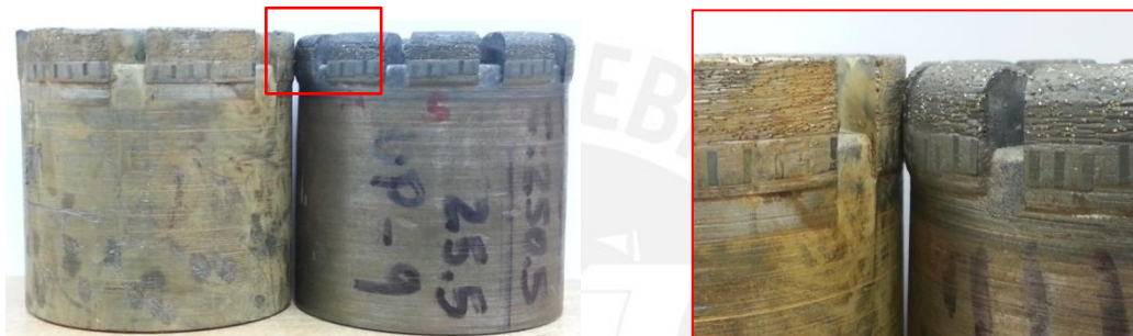
Figura 3.5. Comparación de alturas de impregnación entre la broca de perforación de vías de agua inclinadas, con la broca de perforación de vías de agua radiales (de izquierda a derecha)
