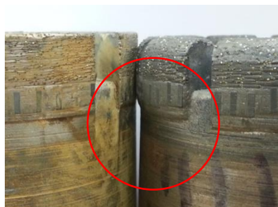
Figura 3.6. Comparación de desgaste de los casquillos de acero entre las brocas con vías de agua inclinadas y vías de agua radiales (de izquierda a derecha).
