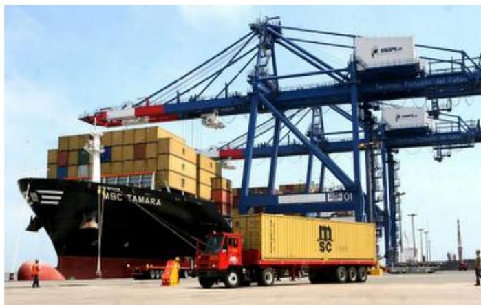
*Figura 31.* Grúas pórtico STS instaladas en el puerto del Callao. Tomado de “Ya operan las grúas pórtico del Callao”, por Desarrollo Peruano, 2009. Recuperado de <http://desarrolloperuano.blogspot.com/2009/04/ya-operan-las-grúas-pórtico-del-callao.html>
