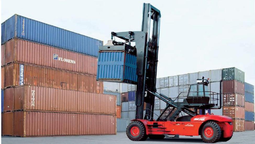
Figura 36. Grúa para contenedores llenos. Tomado de “Laden Container Handler, Gantry Truck, Capacity 88000 lbs / 40000 kg” por Linde, 2012b, p.1.
