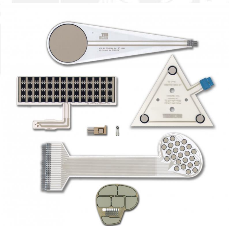
Figura 2.41.- Tipos de sensores de presión flexibles 46 .
