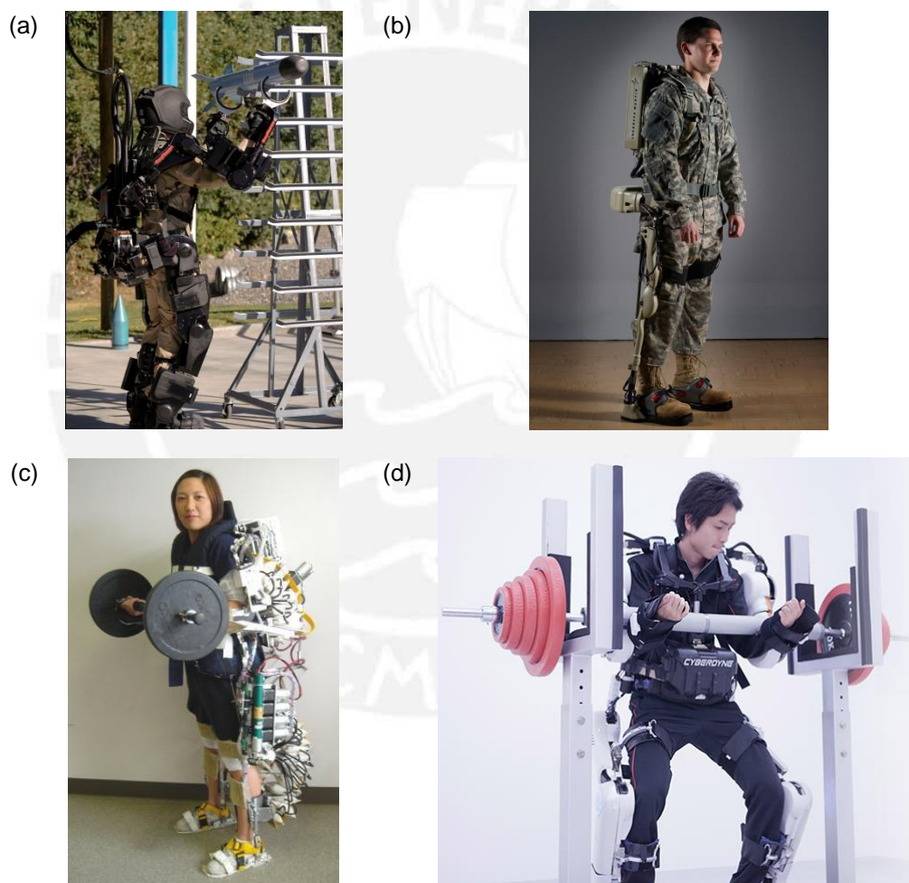
Figura 1.13.- Exoesqueletos amplificadores de fuerza: (a) Raytheon Sarcos XOS 2 15 ; (b) HULC 16 ; (c) Power Assist Suit 17 ; (d) HAL 5 18
