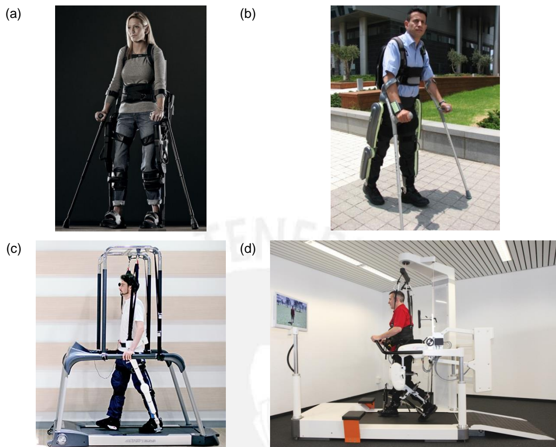
Figura 1.15.- Órtesis activas para asistencia y rehabilitación: (a) Ekso 21 ; (b) ReWalk 22 ; (c) HAL Peripherals 23 ; (d) LokomatPro 24
