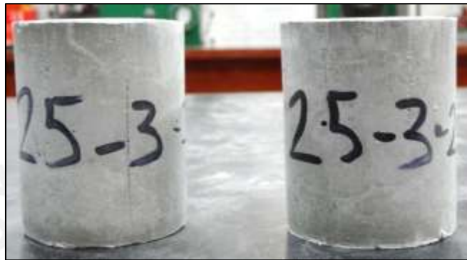
Figura 2. 17 Probetas de compresión medidas y aplanadas
