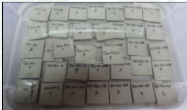
Figura 2.23 Probetas para ensayo de densidad según norma ASTM C1185-08
