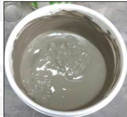
D.- Mezcla cemento y bentonita
