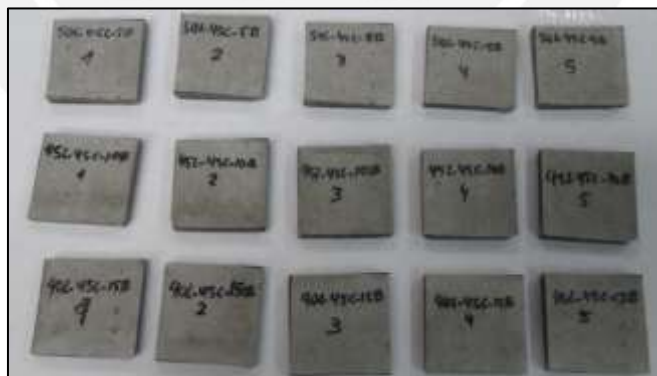
Figura 2. 19 Probetas para ensayo de densidad según norma ASTM C1185-08
