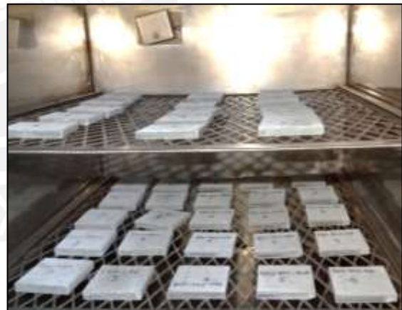
Figura 2. 22 Probetas para ensayos de densidad secadas según norma ASTM C1185-08
