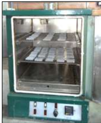
Figura 2. 22 Probetas para ensayos de densidad secadas según norma ASTM C1185-08
